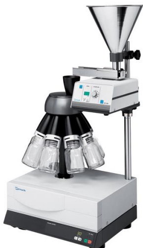
Εικόνα 14. Περιστροφικός διαχωριστής Retsch PT200
