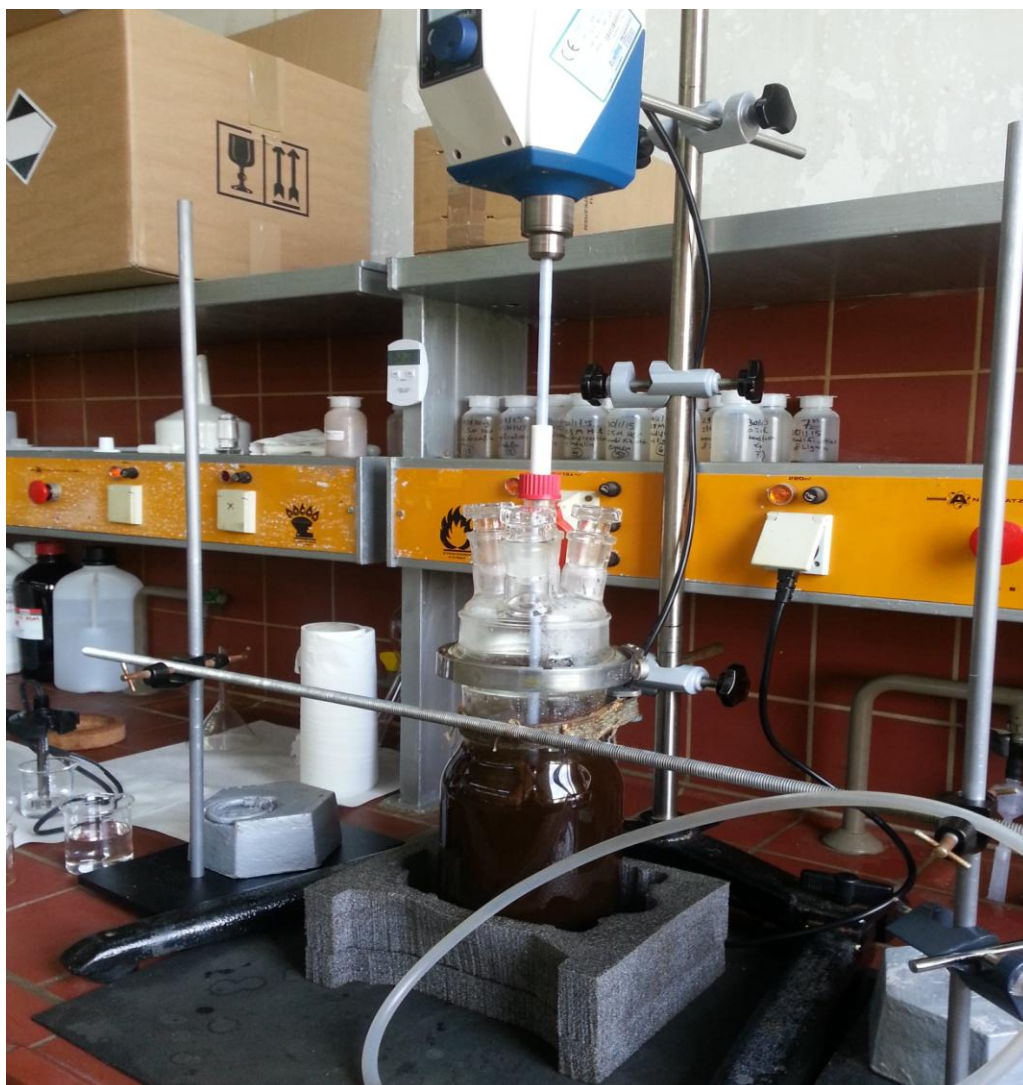
Εικόνα 6.11: Εργαστηριακή διάταξη αντιδραστήρα που δημιουργήθηκε από το εργαστήριο για εκπλύσεις με HCl
