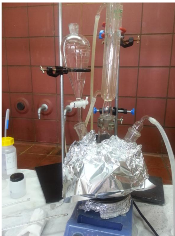
Εικόνα 6.6: Προσθήκη αντιδραστηρίου στάγδην και απαέρωση διαλύματος με άζωτο
