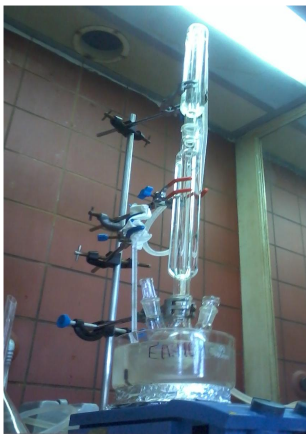
Εικόνα 6.3 :Λόγω υψηλής πτητικότητας της ακετόνης χρησιμοποιήθηκε διπλός ψυκτήρας
