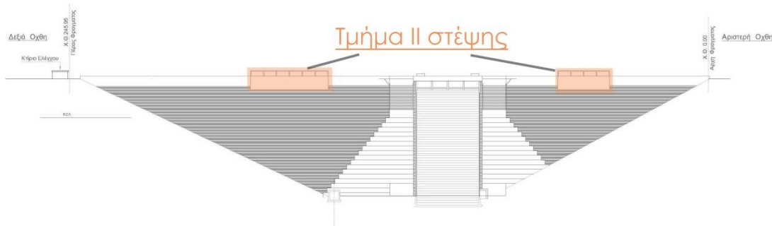
Εικόνα 10.17 Προσδιορισμός τμήματος II της στέψης στην κατάντη όψη του φράγματος.
