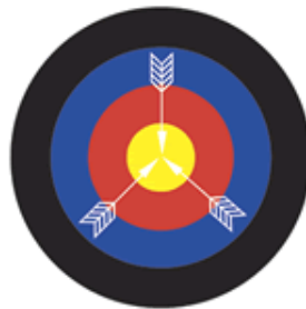
1.4: Αποτέλεσμα με μεγάλη ακρίβεια και μικρή διασπορά. Πρόκειται για το επιθυμητό αποτέλεσμα.
