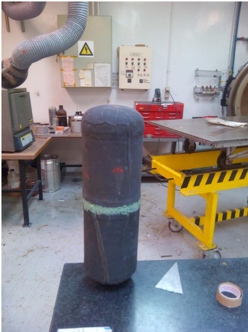
Σχήμα 53: Μορφή δοχείου μετά το secondary bonding
