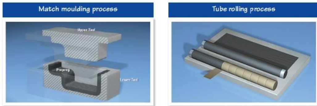
Σχήμα 12: Μορφοποίηση σε πρέσα & tube rolling process [8]
