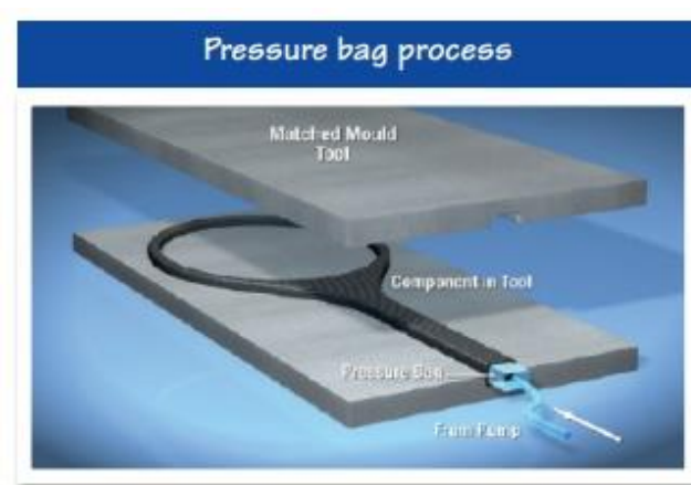
Σχήμα 13: Μορφοποίηση με σακούλα και θετική πίεση [8]
