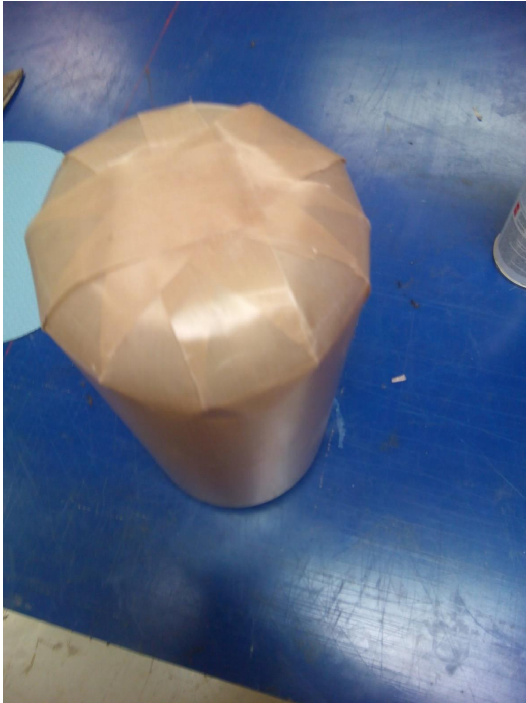
Σχήμα 31: Release film στην κεφαλή
