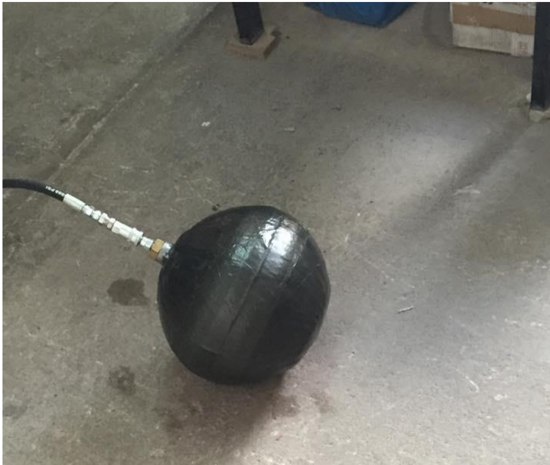
Σχήμα 56: Δοχείο πίεσης συνδεδεμένο με την παροχή αέρα για την επιβολή πίεσης
