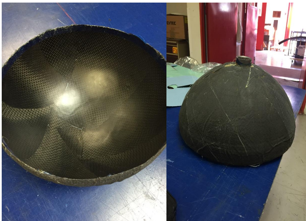
Σχήμα 51: Εσωτερική επιφάνεια κατασκευής (αριστερά), εξωτερική επιφάνεια κατασκευής (δεξιά)
