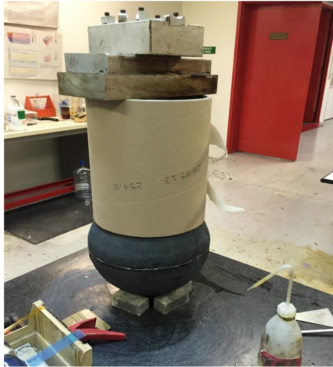
Σχήμα 54: Επιβολή βάρους για στερεοποίηση της κόλλας πριν την εισαγωγή στον φούρνο
