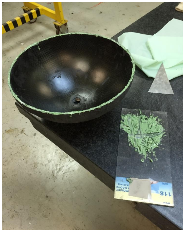
Σχήμα 53: Εφαρμογή κόλλας στην επιφάνεια του χείλους της κατασκευής
