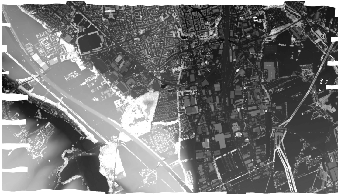
Εικόνα 3.16: Ψηφιακό υψομετρικό μοντέλο επιφανείας πρώτου παλμού μεγίστων τιμών DSM FE Highest values μετά την εφαρμογή του Median Filter
