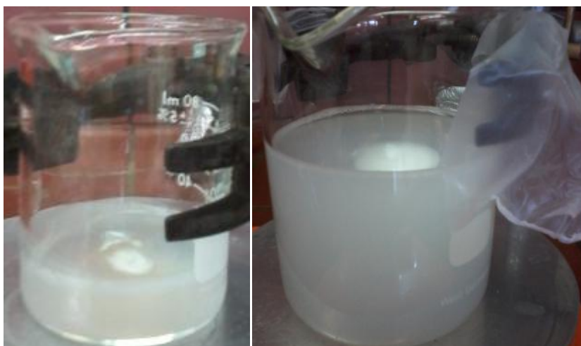
Εικόνα 32 : Σχηματισμός γαλακτώματος κατά την έγχυση της οργανικής στην υδατική φάση στο δείγμα Lemon-NPs-3 (αριστερά) και στο δείγμα Lemon-NPs-4 (δεξιά)
