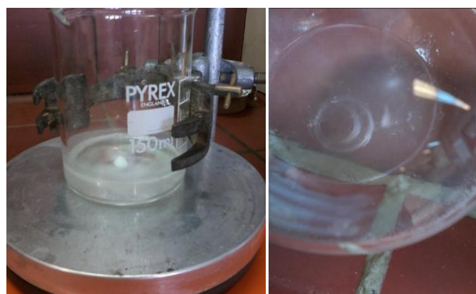
Εικόνα 33 : Σχηματισμός γαλακτώματος κατά την έγχυση της οργανικής στην υδατική φάση στο δείγμα Mandarin-NPs-1 (αριστερά) και Mandarin-NPs-2 (δεξιά)
