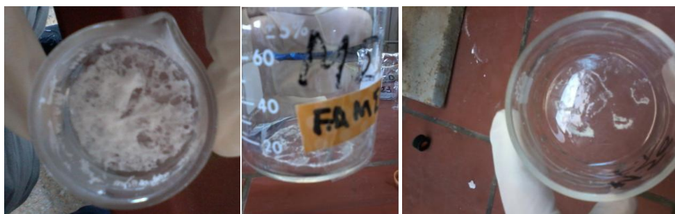
Εικόνα 39 : Λυοφιλοποιημένα νανοσωματίδια Lemon-NPs-4 (αριστερά), Lemon-NPs-1 (κεντρικά) και Mandarin-NPs-1 (δεξιά)
