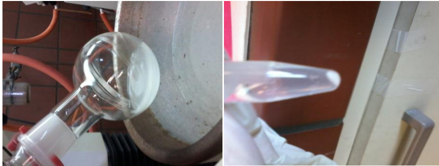
Εικόνα 34 : Γαλάκτωμα κατά την εξάτμιση του DCM (αριστερά) και καταβυθισμένα νανοσωματίδια μετά την 1η φυγόκεντρο (δεξιά) στο δείγμα Mandarin-NPs-3
