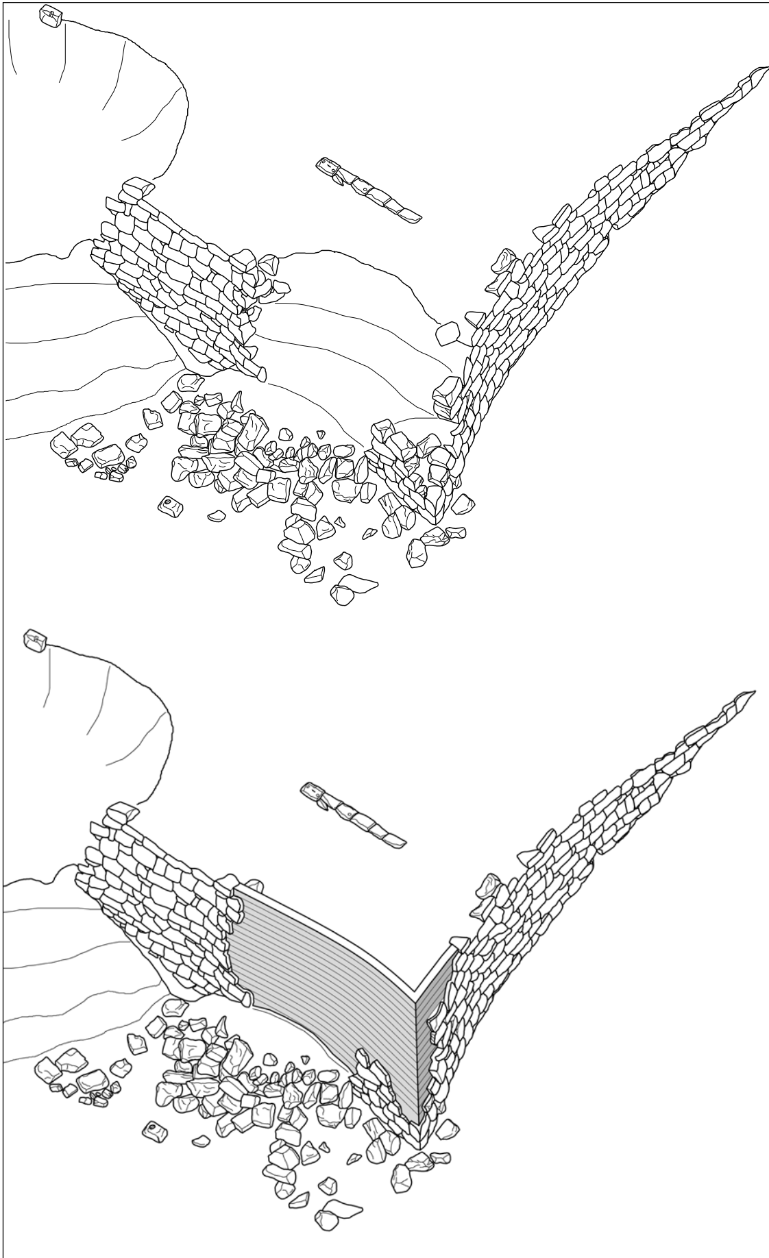
Εικ. 37: Δύο εναλλακτικές προσεγγίσεις της αναστήλωσης. Πάνω: Διατήρηση της εικόνας του αναλήμματος ως έχει με τη μορφή ερειπίου. Στερέωση τοίχων και χωμάτων. Λύση που στερείται νοήματος, αφού δεν επιτελείται ο στατικός ρόλος του αναλήμματος, αντίθετα τονίζεται το γεγονός ότι δεν τον επιτελεί. Κάτω: Αποκατάσταση σχήματος και στατικής λειτουργίας με χυτό υλικό που ομοιάζει των κροκαλοπαγών λίθων. Θα επρόκειτο για μια συνεπή λύση μόνο εφόσον όλο το ελλείπον οικοδομικό υλικό δεν είχε βρεθεί και είχε χαθεί οριστικά π.χ. από λεηλασία.
