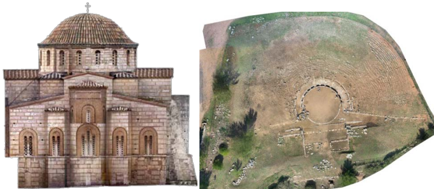
εικ. 2: Αριστερά: Ορθοφωτογραφία όψης Καθολικού Μονής Δαφνίου, Δεξιά: Κάτοψη αρχαίου θεάτρου Εργαστήριο Φωτογραμμετρίας ΕΜΠ
