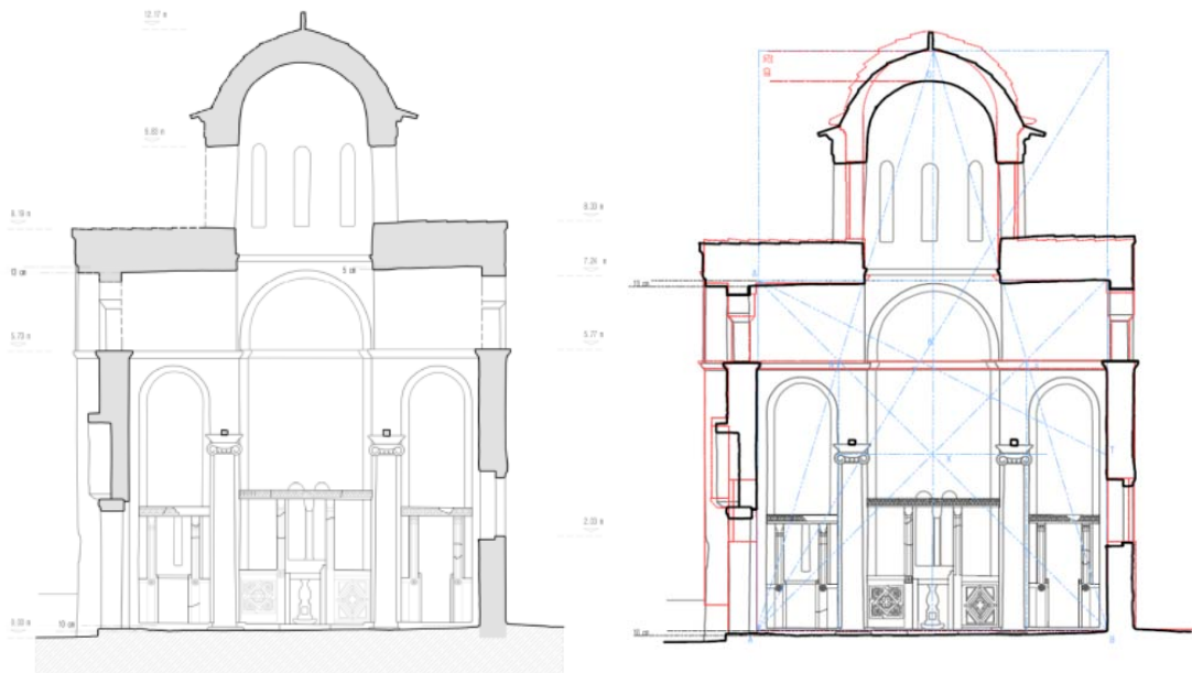
εικ.: (αριστερά) εγκάρσια τομή αρχιτεκτονική αποτύπωση, (δεξιά) εφαρμογή "αρμονικών χαράξεων" και σύγκριση
