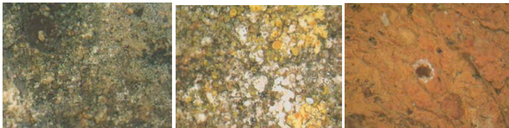
εικ.: 1. πωρόλιθος με μαύρη βιοδιάβρωση / 2. πωρόλιθος με μαύρη λευκή και κίτρινη βιοδιάβρωση με καρπικές δομές / 3. οπτόπλινθος με μικρορηγματώσεις και μικροαποφλοιώσεις
