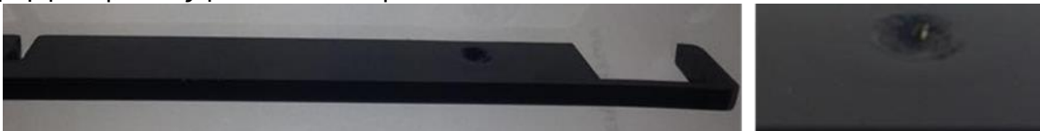
Εικόνα 31:Κινούμενο μέρος. Παραμόρφωση από δέσμη φωτός.
