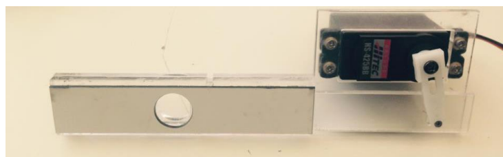
Εικόνα 29: Διάφραγμα (πριν βαφτεί το κινούμενο με μαύρο χρώμα)
