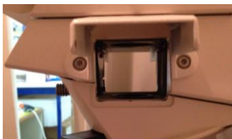
Εικόνα 39: Πλάγια όψη του Μικροσκοπίου που παρουσιάζει τον οδηγό της κίνησης του φορέα των οπτικών φίλτρων, το κάλυμμα για τη σκόνη και οι δύο βίδες που συγκρατούν το κάλυμμα
