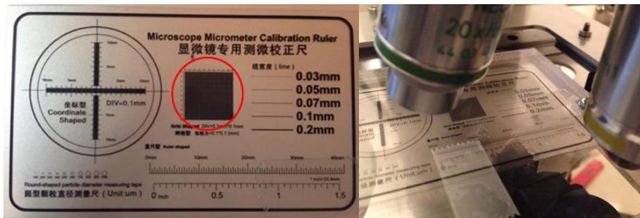
Εικόνα 99: (Αριστερά) Φίλτρο βαθμονόμησης μικροσκοπίου με ακρίβεια μικρομέτρου, (Δεξιά) Απεικόνιση φίλτρου βαθμονόμησης στο μικροσκόπιο.
