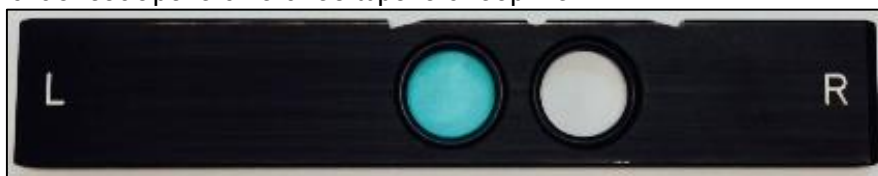
Εικόνα 19: Υπάρχον διάφραγμα μπλοκαρίσματος δέσμης λάμπας υδραργύρου
