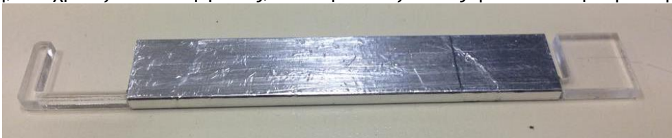
Εικόνα 32: Κινούμενο μέρος καλυμμένο με ταινία αλουμινίου
