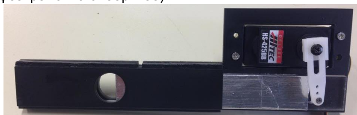
Εικόνα 34: Διάφραγμα. Μετά τη βαφή και με το κινούμενο καλυμμένο με ταινία αλουμινίου
