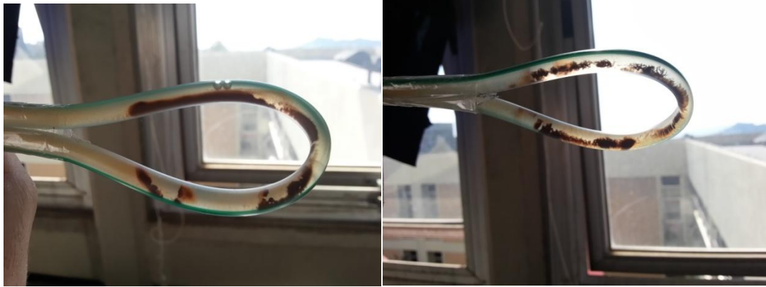
Σχήμα 1.18: Συγκράτηση μαγνητικών σωματιδίων με έξι πυρήνες στο κέντρο και στις ακμές
