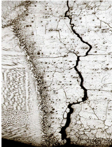
Εικόνα 11 Strain age cracking σε προσομοιωμένη επιδιορθωτική συγκόλληση στο Rene 41
