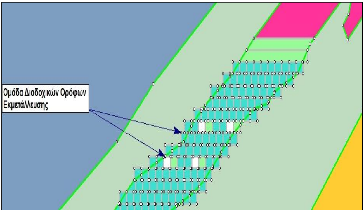
Εικόνα 20. Στοές υπό εκμετάλλευση σε ανώτερο υψομετρικά επίπεδο, λιθογόμωση ως δάπεδο και ανώτερη περιοχή πλήρως εξοφλημένη και λιθογομμωμένη. Στάδιο 22°.
