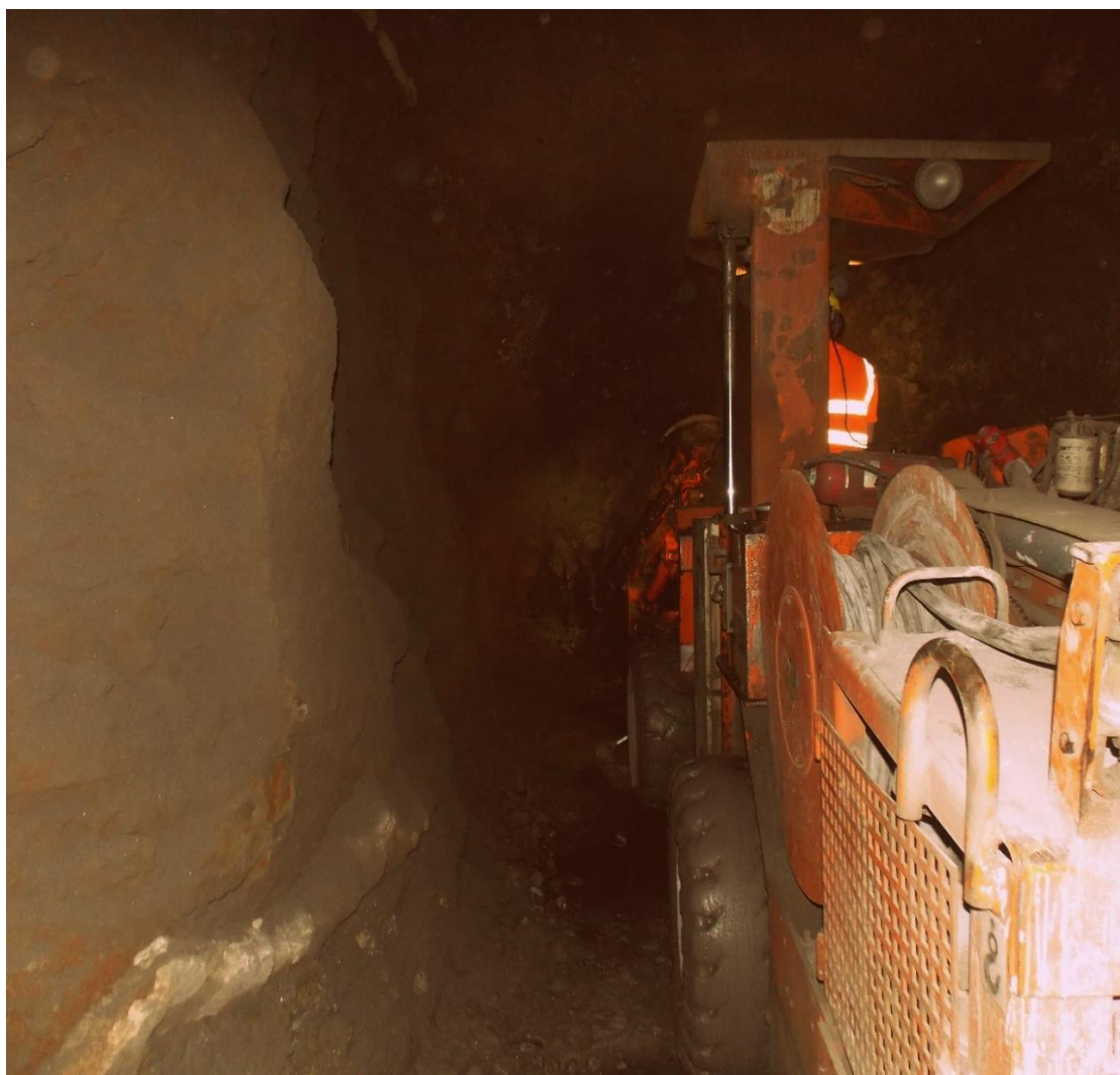
Εικόνα 1. Διατηρητικό μηχάνημα Jumbo κινείται παράλληλα σε λιθογομωμένη στοά (στα αριστερά), η οποία λειτουργεί ως οδηγός της νέας στο μεταλλείο των Μαύρων Πετρών.
