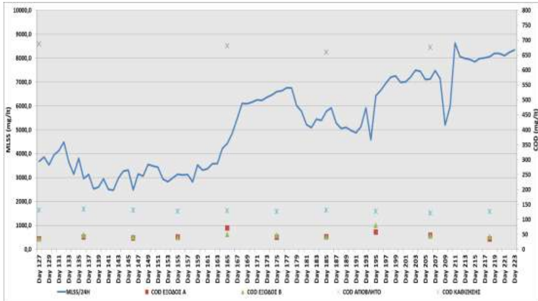
Διάγραμμα 8.5 Πορεία COD (εισόδου, εξόδου, και διαυγασμένου υγρού) της πιλοτικής μονάδας MBR.
