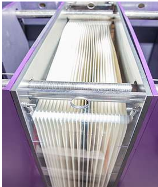
Εικόνα 4.8 : Μεμβράνη με επίπεδα φύλλα (flat sheet membrane)
