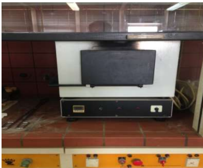
Εικόνα 6.12 Κλίβανος στους 550 ± 50 °C
