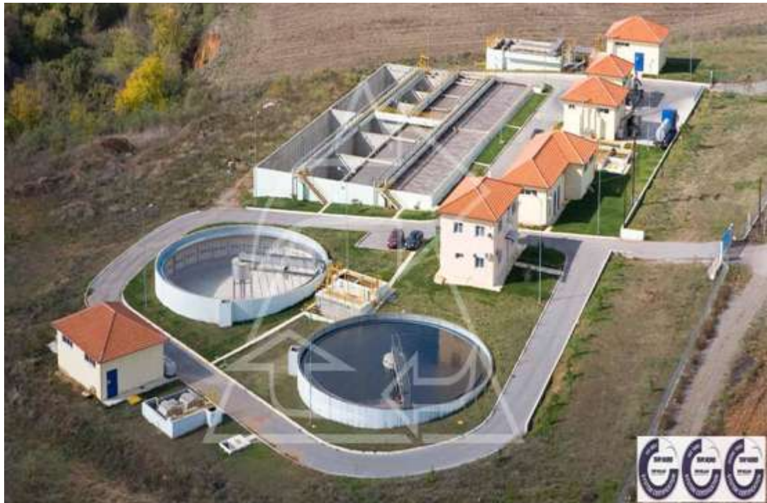
Εικόνα 4.4 : Συμβατικό σύστημα Ενεργούς Ιλύος (ΕΙ) Δήμου Κιλκίς
