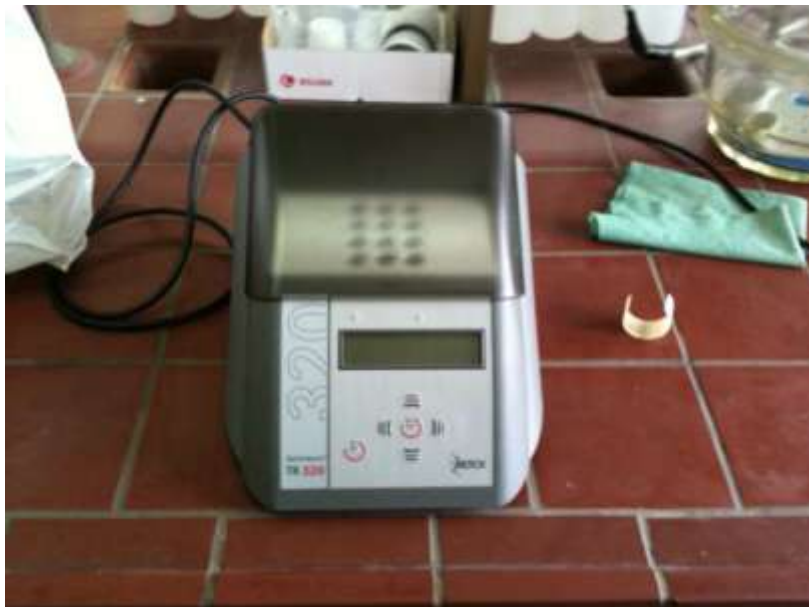
Εικόνα 6.3 Θερμοαντιδραστήρας Merck TR 320
