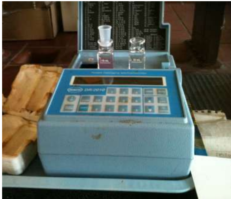
Εικόνα 6.5 Φασματοφωτόμετρο Hach DR 2010
