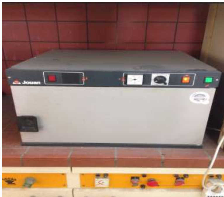
Εικόνα 6.11 Φούρνος ξήρανσης στους 103 °C -105° C
