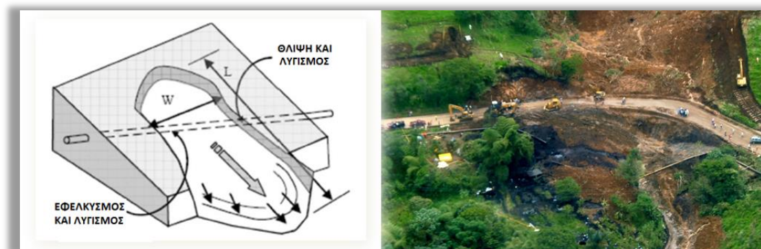
Εικόνα 3-7 : Αριστερά σχηματική αναπαράσταση άσκησης τάσεων στον αγωγό από εδαφική ροή και δεξιά θραύση αγωγού στο Εκουαδόρ, λόγω αυτού του φαινομένου. (Πηγή: Ίδια Επεξεργασία από: Nyman (2008) και American Geophysical Union (2009).
