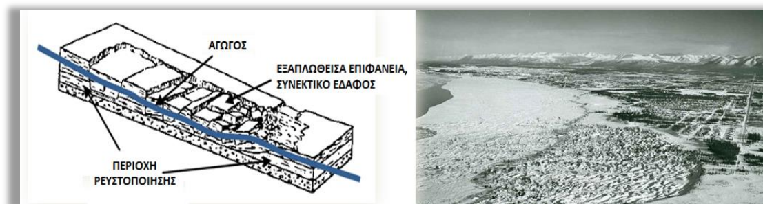
Εικόνα 3-6: Πλευρική εξάπλωση. Αριστερά σχηματική αναπαράσταση ολίσθησης εδαφικής ζώνης πάνω από ζώνη ρευστοποιημένου ιζήματος και δεξιά μία πραγματική περίπτωση από περιοχή του Καναδά. (Πηγή: Nyman, 2008)
