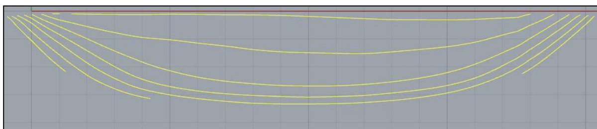
Εικόνα 4.29. Ίσαλοι από το μοντέλο με μέθοδο με scanner
