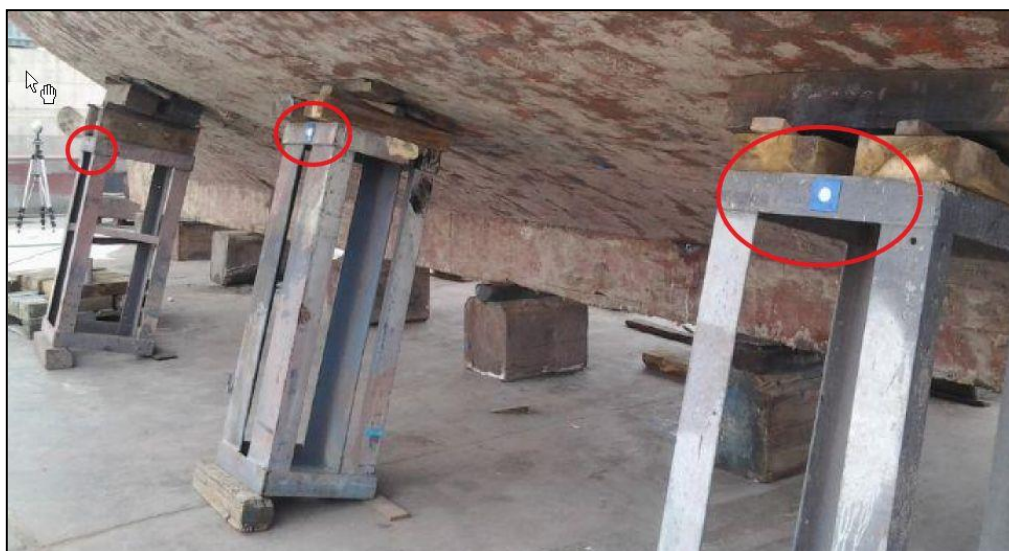
Εικόνα 4.5. Τα αυτοκόλλητα στόχοι (από αριστερά προς δεξιά: K3, K4, K5)
