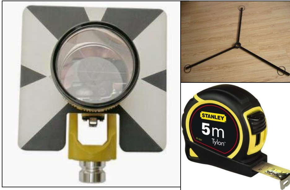
Εικόνα 3.3. Αριστερά: Πρίσμα. Πάνω δεξιά: Αράχνη. Κάτω δεξιά: Μετροταινία
