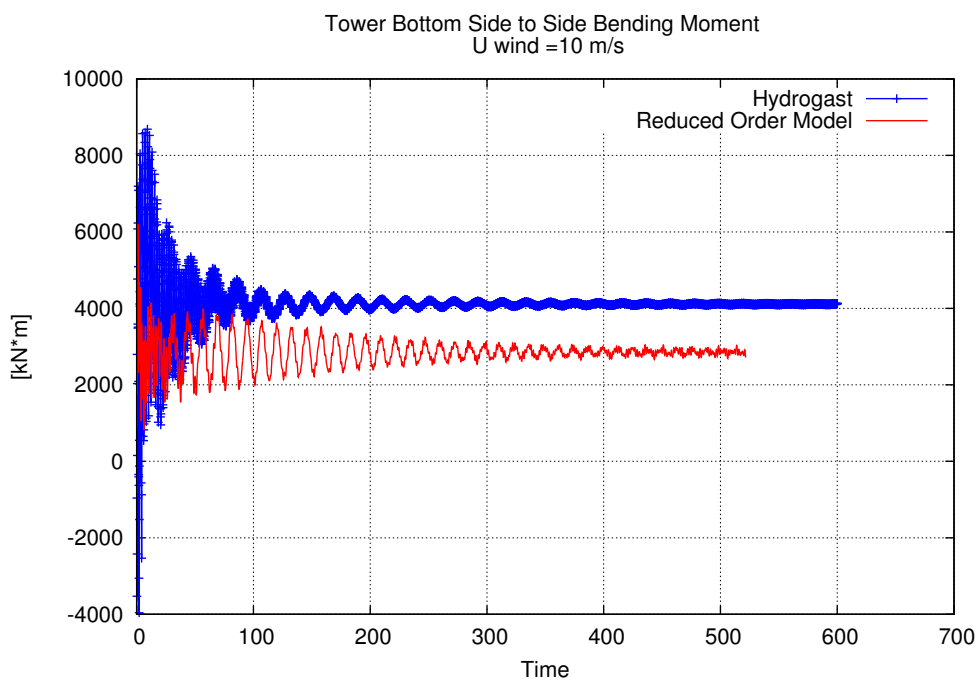
Σχήμα 8.5: Ροπή roll πύργου πλωτής ανεμογεννήτριας στα 10m/s
