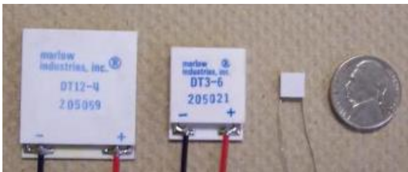
Εικόνα 4.13: TECs διαφόρων μεγεθών από την εταιρία Marlow ( http://www.ferrotec.com/technology/thermoelectric )
