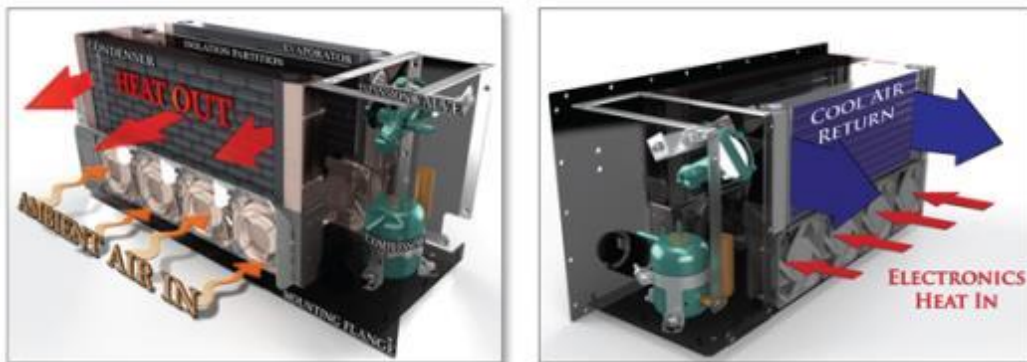
Εικόνα 1.12: Μοτίβα ροής αέρα εκτός (αριστερά) και εντός της μονάδας ελέγχου ψύξης με αέρα ( http://www.electronics-cooling.com/2014/05/advances-vapor-compression-electronics-cooling/ )
