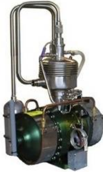
Εικόνα 5.10: Διάταξη εν σειρά συμπυκνωτή - υγροποιητή κρυογονικών υγρών (Garrett, S. 1993)
