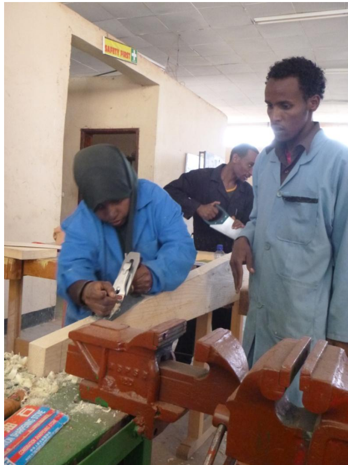
Σχήμα 1.5: Κατασκευή των πτερυγίων μικρής ανεμογεννήτριας από τους ίδιους τους χρήστες της σε μια κοινότητα της Αιθιοπίας.
