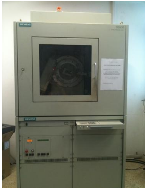
Σχήμα 23: Συσκευή περιθλασιμετρίας ακτίνων - X
