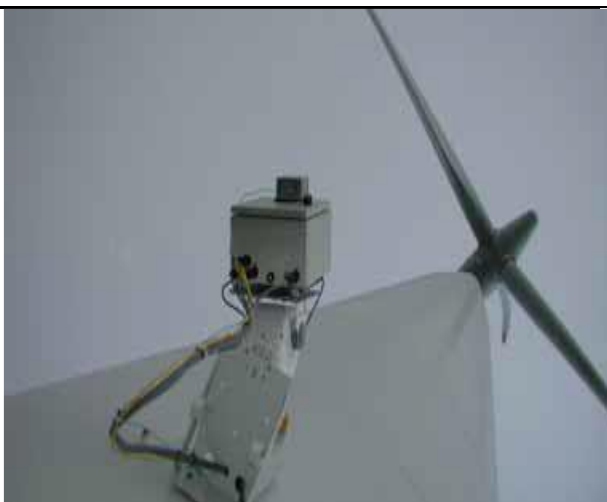
Σχήμα 5.5.2: Θερμική κάμερα για την παρακολούθηση της κίνησης των πουλιών τοποθετημένη σε ανεμογεννήτρια στο Nysted Photo: Mark Desholm Πηγή: Larsen κ. συν. 2006
