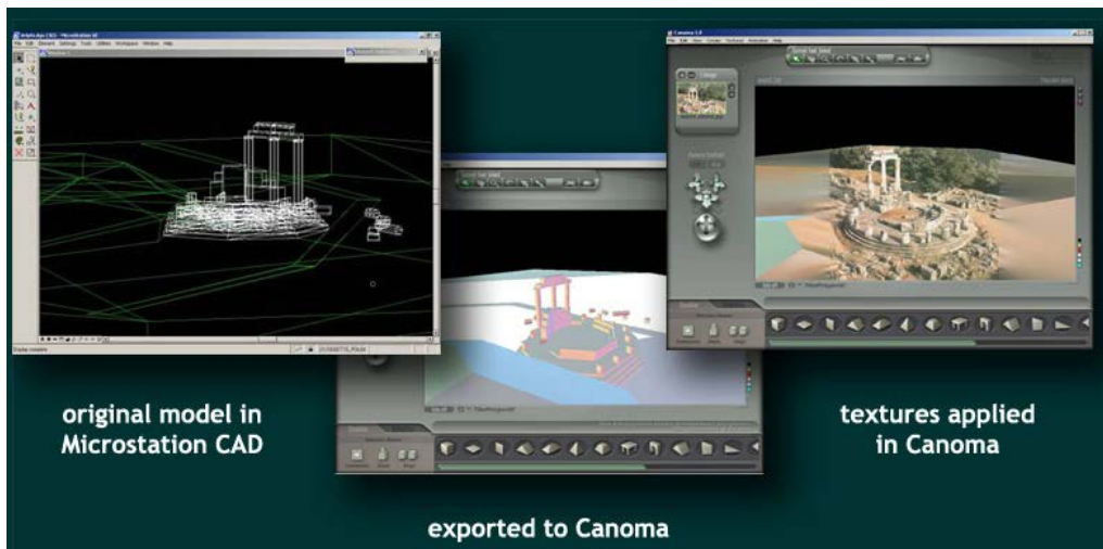
Εικόνα 3.10.: Παρουσίαση του λογισμικού Canoma με το αρχικό μοντέλο σε πρόγραμμα σχεδίασης CAD, τη δημιουργία της επιφάνειάς του στο Canoma και την τελική απόδοση της υφής σε αυτό.
