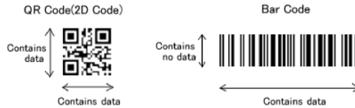
Εικόνα 3.6.: Η κατανομή πληροφοριών σε QR Codes και Barcodes.
