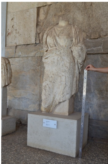
Εικόνα 4.6.: Χρήση του χάρακα με τους προσημασμένους στόχους κατά τη διάρκεια της λήψης των εικόνων.
