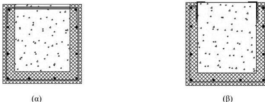
Σχήμα 3-15 Ενίσχυση υποστυλώματος με μανδύα ανοικτού τύπου
