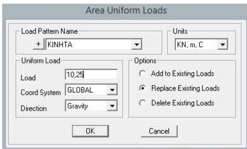
Εικόνα 4-53 Επιβολή κινητών φορτίων
