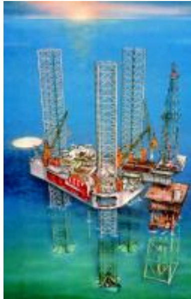
Εικ. 1.12 Jack-up εξέδρα 116C της Le Tourneau με πρόβολο στήριξης του μηχανισμού γεώτρησης πάνω από σταθερή πλατφόρμα. Αντίστοιχος σχεδιασμός με τις σημερινές jack-up εξέδρες [9].
