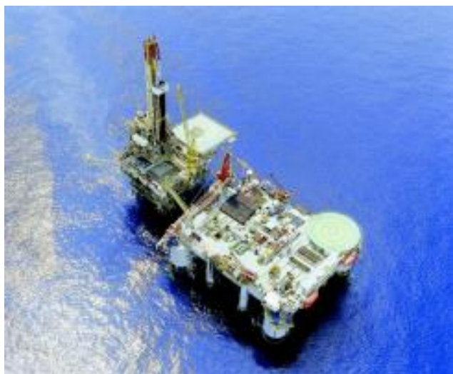
Εικ. 1.18 Η εξέδρα Seahawk, η πρώτη ημιβυθισμένη εξέδρα TAD παγκοσμίως. Μετατράπηκε από μία κινητή μονάδα υπεράκτιας εξόρυξης (MODU) το 1992 [10].
