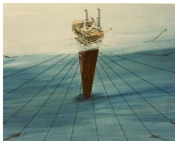
Εικ. 1.22 Η πλατφόρμα Lena της ExxonMobil. Είναι η πρώτη πλατφόρμα Guyed Tower και κατασκευάστηκε το 1984 στον κόλπο του Μεξικού [11].
