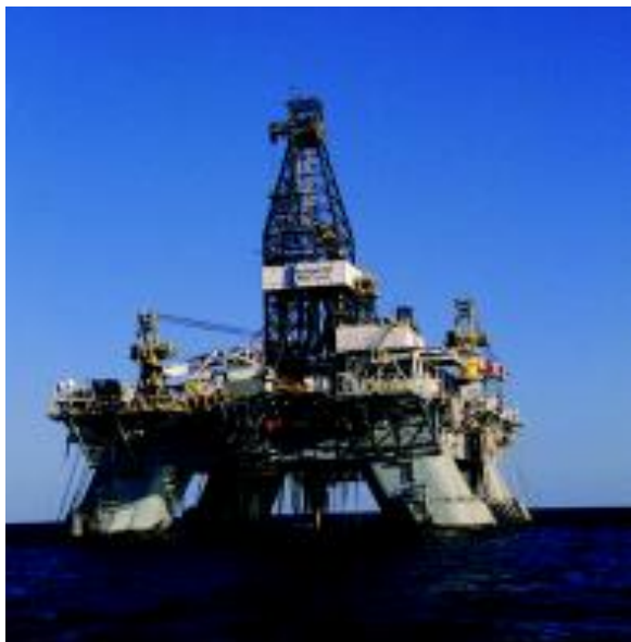
Εικ. 1.16 Deepwater Nautilus, μια από τις πιο νέες ημιβυθισμένες εξέδρες πέμπτης γενιάς που έχει σύστημα υποβοήθησης για την διατήρηση της θέσης της. Παρατηρήστε τις φαρδιές κολόνες για αυξημένο μεταβλητό φορτίο και ευστάθεια [10].
