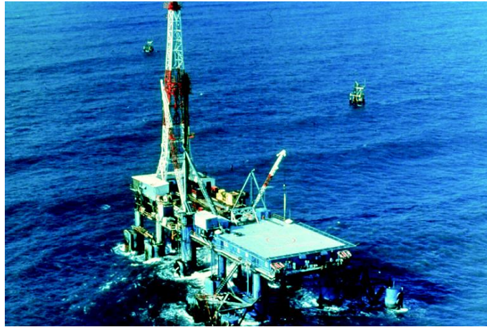
Εικ. 1.2 Εξέδρα Mr. Charlie, η πρώτη ουσιαστικά εξέδρα τύπου MODU. Κατασκευάστηκε το 1954 και λειτούργησε ως το 1986. Τώρα λειτουργεί σαν μουσείο και εξέδρα εκπαίδευσης στην πόλη Morgan της Λουιζιάνα [6].
