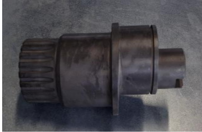
Σχήμα 5.4. Ο εκκεντροφόρος άξονας του εκτονωτή
