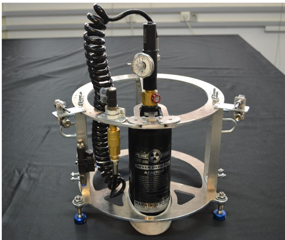
Σχήμα 1-3. Ο σκελετός του δεύτερου ρομπότ με μία φιάλη CO 2 .
