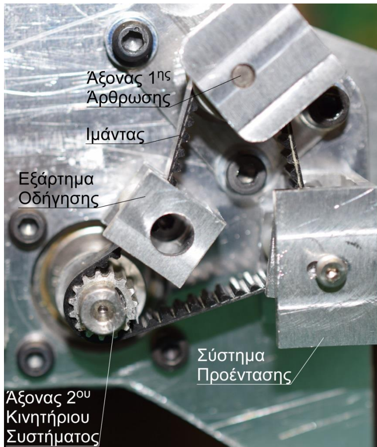
Σχήμα 2-35. Άποψη της βάσης πρόσδεσης των βραχιόνων – βλέπε και Σχήμα 2-23.
