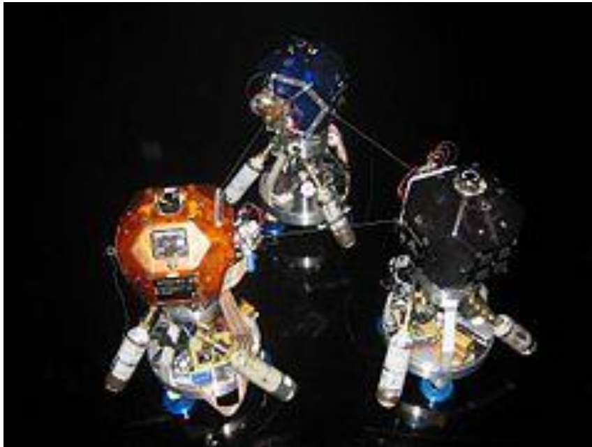
Σχήμα 1-8. SPHERES, επίπεδος διαστημικός εξομοιωτής. Εκτελείται δοκιμή πτήσης σε σχηματισμό ισόπλευρου τριγώνου επί της γυάλινης τράπεζας του διαστημικού εξομοιωτή.
