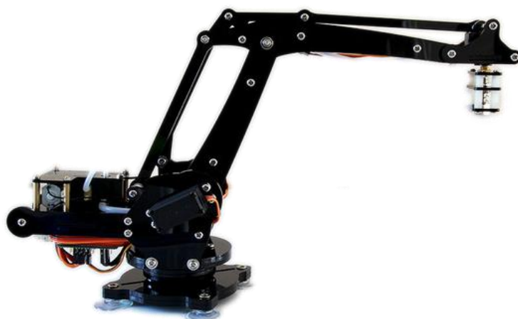
Σχήμα 2-6. Υλοποίηση ρομποτικού βραχίονα με ράβδους ώθησης-έλξης.
