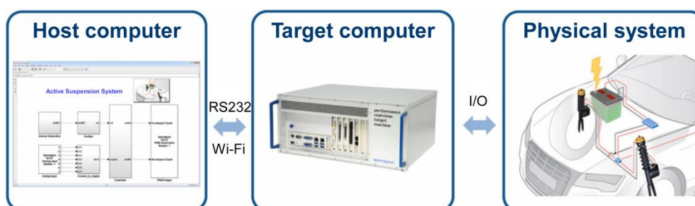
Σχήμα 5-3. Διαμόρφωση συστήματος για δοκιμές με Simulink Real-Time. Το πρόγραμμα ελέγχου αναπτύσσεται στον Host computer ως γραφικό διάγραμμα. Έπειτα, μετατρέπεται σε εκτελέσιμο πραγματικού χρόνου και φορτώνεται στο Target computer μέσω RS232 ή Wi-Fi. Το σύστημα ελέγχου τρέχει σε αυστηρώς πραγματικό χρόνο στον Target computer, ο οποίος ελέγχει το πραγματικό σύστημα μέσω των I/O του υλικού.
