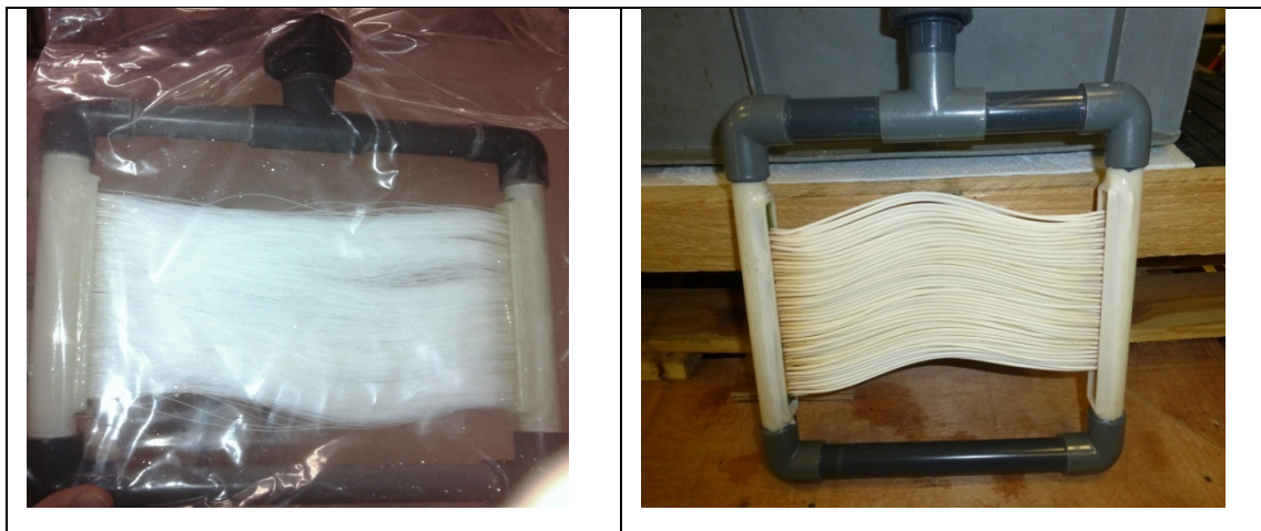
Εικόνα 5: Φωτογραφία των στοιχείων μεμβρανών κοίλων ινών
