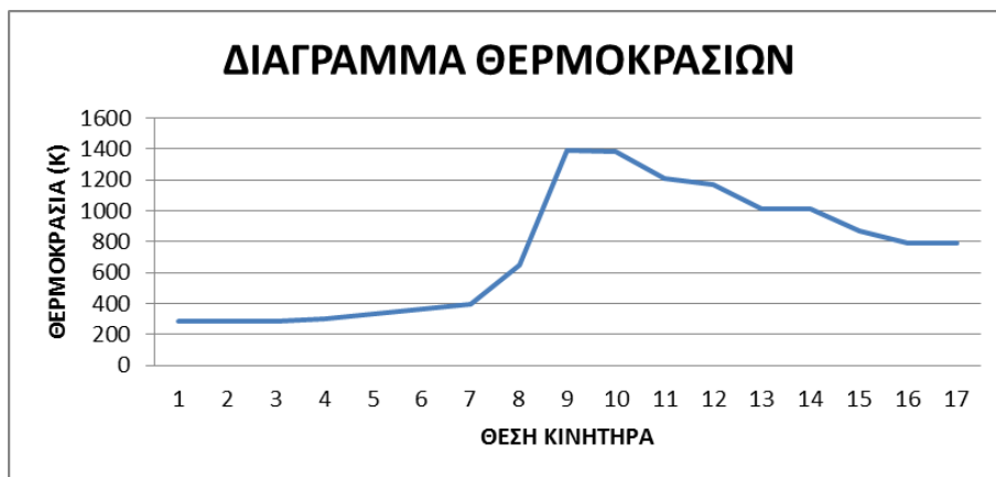
Σχήμα 4.38: Διάγραμμα θερμοκρασιών κατά μήκος του κινητήρα, όπως προέκυψε από την ψηφιοποίηση εικόνας στο Σχήμα 4.36
