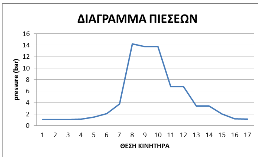
Σχήμα 4.37: Διάγραμμα πιέσεων κατά μήκος του κινητήρα, όπως προέκυψε από την ψηφιοποίηση εικόνας στο Σχήμα 4.36
