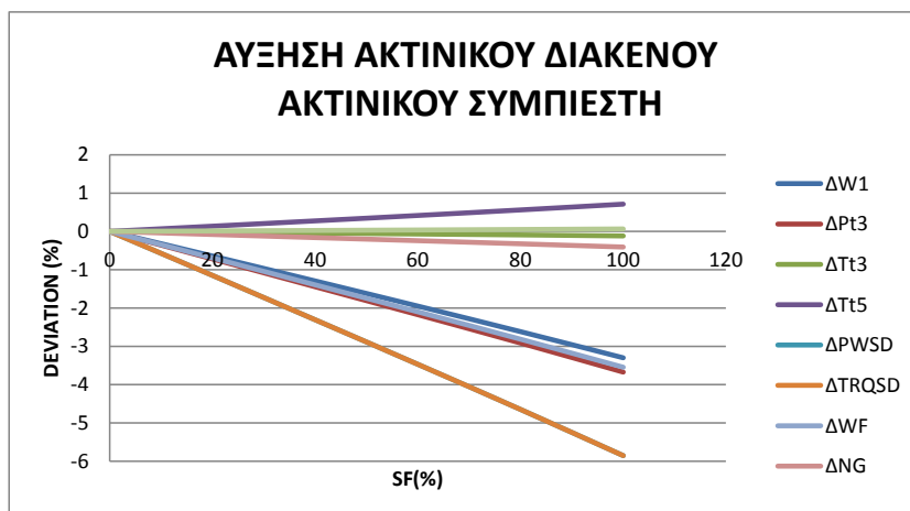
Σχήμα 7.1: Αποκλίσεις των μεγεθών συναρτήσει του SF (%) για αύξηση του ακτινικού διακένου του αξονικού συμπιεστή
