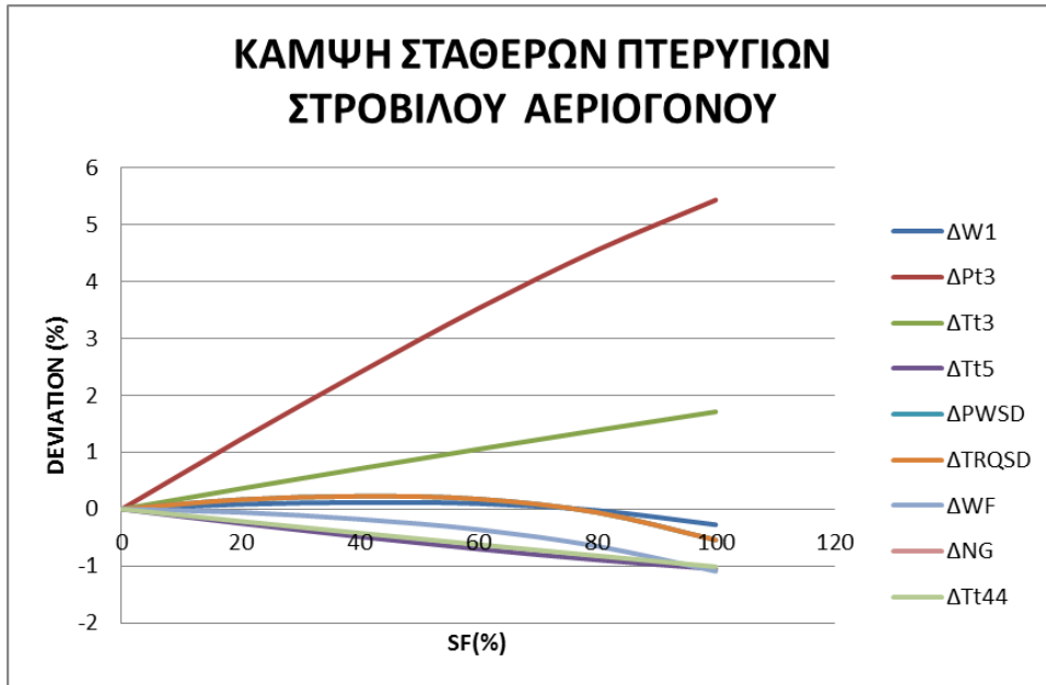
Σχήμα 7.13: Αποκλίσεις των μεγεθών συναρτήσει του SF (%) για κάμψη των σταθερών πτερυγίων του στροβίλου της αεριογόνου
