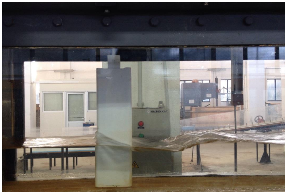
Σχήμα 2.3 Ροή σε ορθογωνική διάρρυγα με μεσόβαθρο.
