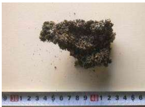
Εικόνα 4.2: Συσσωμάτωμα από την αεριοποίηση αγριαγκινάρας με ολιβίνη
