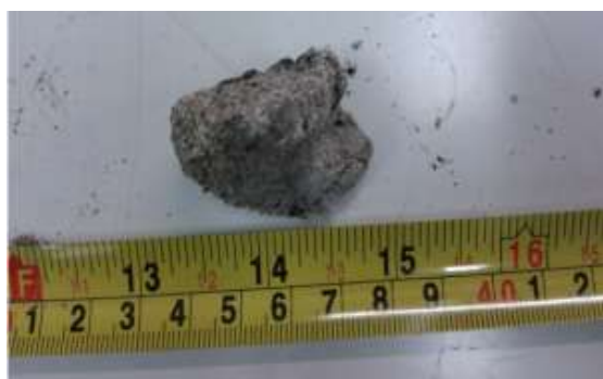
Εικόνα 4.6. Φωτογραφία ενός συσσωματώματος σωματιδίων μαγνησίτη με ανόργανα στοιχεία της τέφρας της αγριαγκινάρας
