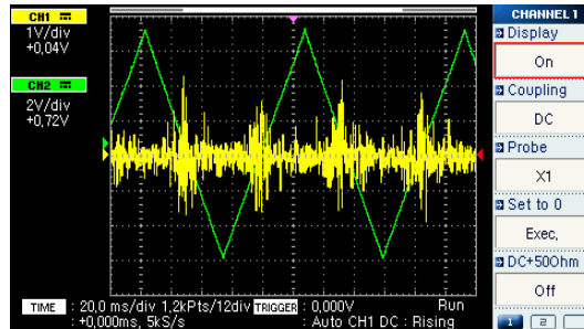
Εικόνα 4-10: Απεικόνιση στον ψηφιακό παλμογράφο, του τριγωνικού σήματος διέγερσης (πράσινη κυματομορφή) και μιας σημειακής ενδεικτικής μέτρησης του μαγνητικού θορύβου Barkhausen (κίτρινη κυματομορφή) στην επιφάνεια συγκολλημένου δείγματος.
