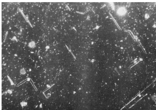
Εικόνα 1-1: Μαγνητικές περιοχές τριγωνικής και γωνιάδους μορφολογίας σε Fe-3%Si χάλυβα [23].
