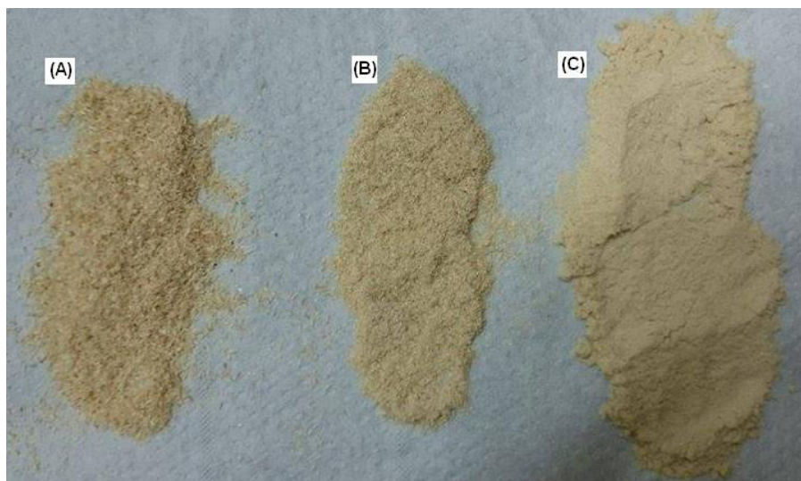
Εικόνα 3.2: Μορφή των ινών (A) Lignocel® BK 40-90, (B) Arbocel® C320, (C) Arbocel® C100
