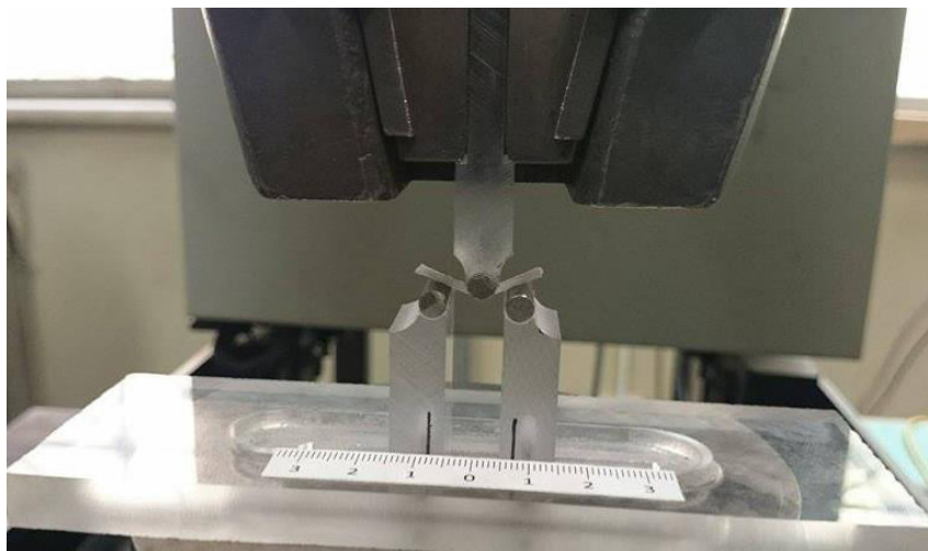
Εικόνα 3.20: Ιδιοκατασκευή για τη δοκιμή της κάμψης
