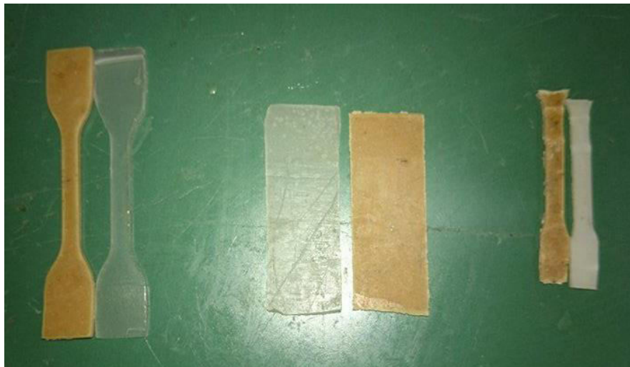
Εικόνα 3.8: Δοκίμια εφελκυσμού αριστερά, κάμψης στο κέντρο και εφελκυσμού στο DMA δεξιά
