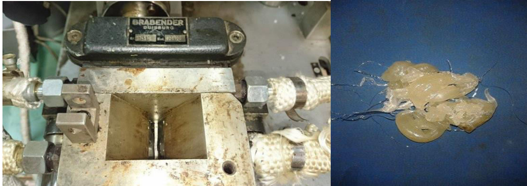
Εικόνα 3.5: Παράθυρο ανάδευσης του αναμεικτήρα και η μάζα με τη μορφή που εξάγεται μετά το πέρας της ανάμιξης
