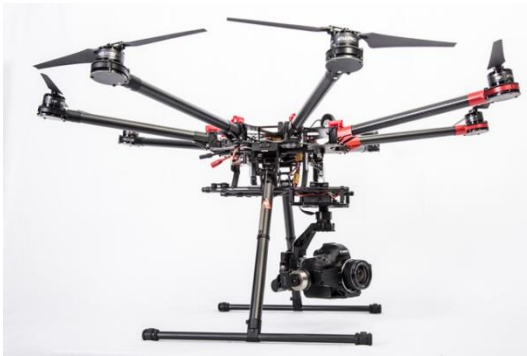
Εικόνα 3.2: (αριστερά) η Canon EOS 5DS τοποθετημένη στο Dji Spreading Wings S1000 Octocopter, και (κάτω) εικόνα από αέρος με την Canon EOS 5DS και φακό 28 mm από υψόμετρο 121m ( adamtech.com.au )
