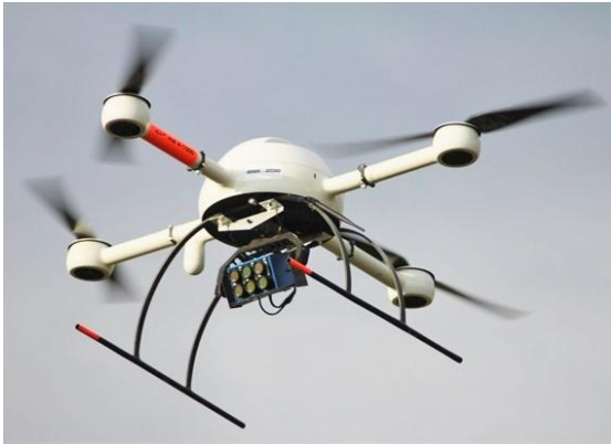
Εικόνα 3.3: (αριστερά) η MIni-MCA6 της Tetracam, τοποθετημένη στο md4-1000 της Microdrones, και (κάτω) πολυφασματικές απεικονίσεις από την MIni-MCA6 (tetracam.com)
