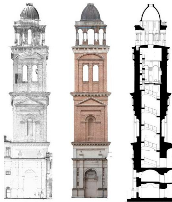
Εικόνα 2.13: το καμπαναριό της Santa Barbara. Δεδομένα από τον επίγειο σαρωτή, ορθοεικόνα και τελική κατακόρυφη τομή που εξήχθη με την χρήση και των δύο τεχνικών. (Fregonese et al., 2015).
