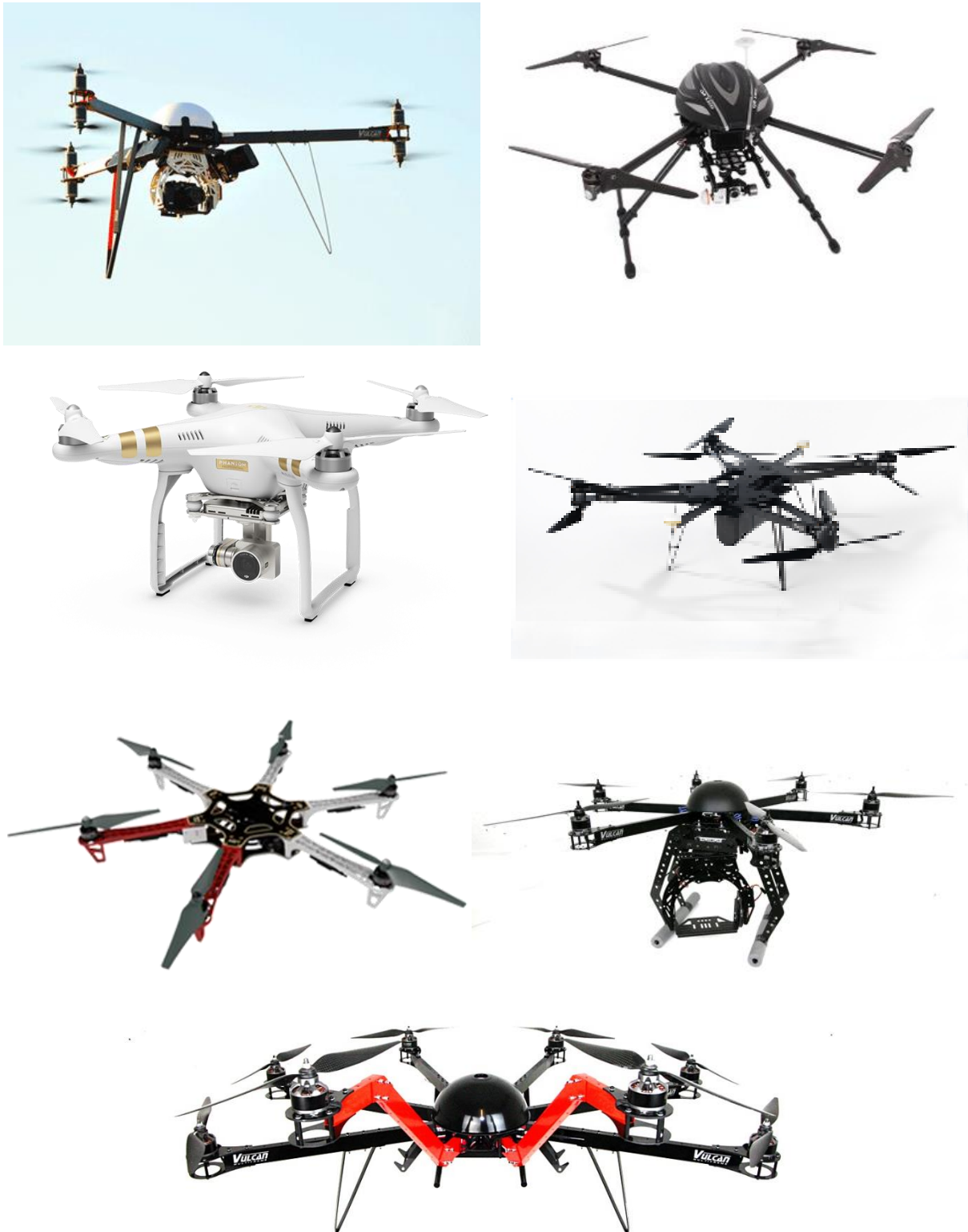
Εικόνα 1.1: UAV πολλαπλών στροφείων(από πάνω προς τα κάτω και από αριστερά προς τα δεξιά), Vulcan Y6 Pro System tricopter, WALKERA QR X800 quadcopter, DJI Phantom 3 quadcopter, Vulcan LDH8 quadcopter, DJI Flame wheel hexacopter, Vulcan MANTIS HexaBeast Pro System hexacopter, Vulcan MANTIS Octo 1080 PRO octocopter (dji.com, Vulcan.com & walkera.com)
