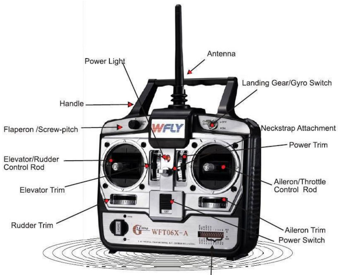
Εικόνα 4.13: Τα χαρακτηριστικά του WFT06X-A της WFLY (uavcoach.com)
