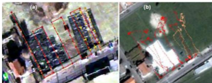
Εικόνα 2.2: (a)Ο προγραμματισμός πτήσης στην ορθοεικόνα του Quickbird, (b)οι πραγματικές τροχιές που ακολούθησε η εναέρια πλατφόρμα (με κόκκινο χρώμα περιγράφεται η υψηλότερη και με κίτρινο χρώμα η χαμηλότερη) τροχιά(Rinaudo et al., 2012).
