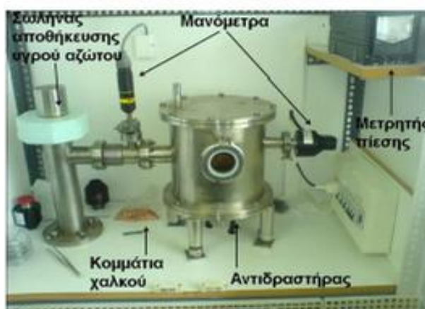
Σχήμα 29: Αναπαράσταση ολόκληρης της διάταξης (εκτός αντλιών) του εξαχνωτή χαλκού.
