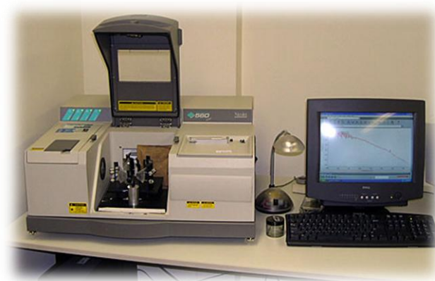
Εικόνα 2.1.2 Φασματόμετρο υπερύθρου FT-IR MAGNA-IR 560, Nicolet όπου διακρίνεται και ο δειγματοφορέας στερεών δειγμάτων.
