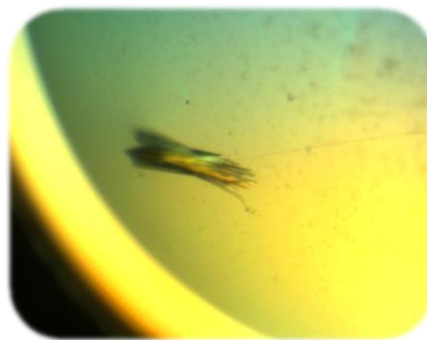
Εικόνα 3.4.9 Ο S213A μονοκρύσταλλος που εκτέθηκε στην ακτινοβολία συμβατικής πηγής ακτίνων X στο IBΦXB (ΕΙΕ) και αναπτύχθηκαν σε συνθήκες κρυστάλλωσης 0.1M \text{CH}_3\text{COONa} , pH 4.6 και PEG550 MME 25% (v/v).
