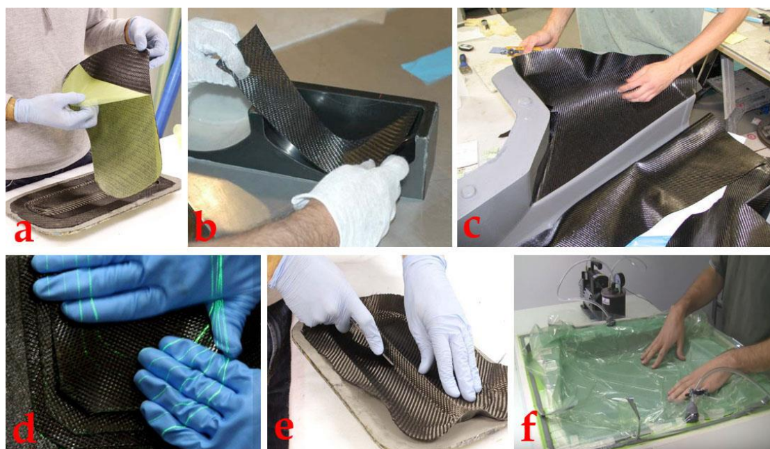
Εικόνα 6-1: Χειροποίητη στρώση (hand lay-up ) σύνθετων ινωδών ανθρακούφασμάτων. [© easycomposites™ website http://goo.gl/v0ScTv ]
