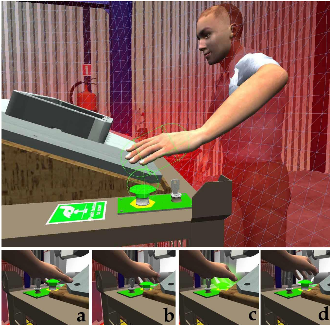
Εικόνα 7-9: Επάνω, το ανθρωποειδές εισέρχεται στο χώρο εργασίας του ρομπότ και πατάει το πράσινο κουμπί έναρξης. Κάτω, η υλοποίηση της μεταφοράς του πατήματος κουμπιού: (a) επαφή (isTrigger), (b) πάτημα/κίνηση (c) οριακή κάτω θέση (ήχος «κλικ» και φωτεινή λάμψη), (d) επαναφορά
