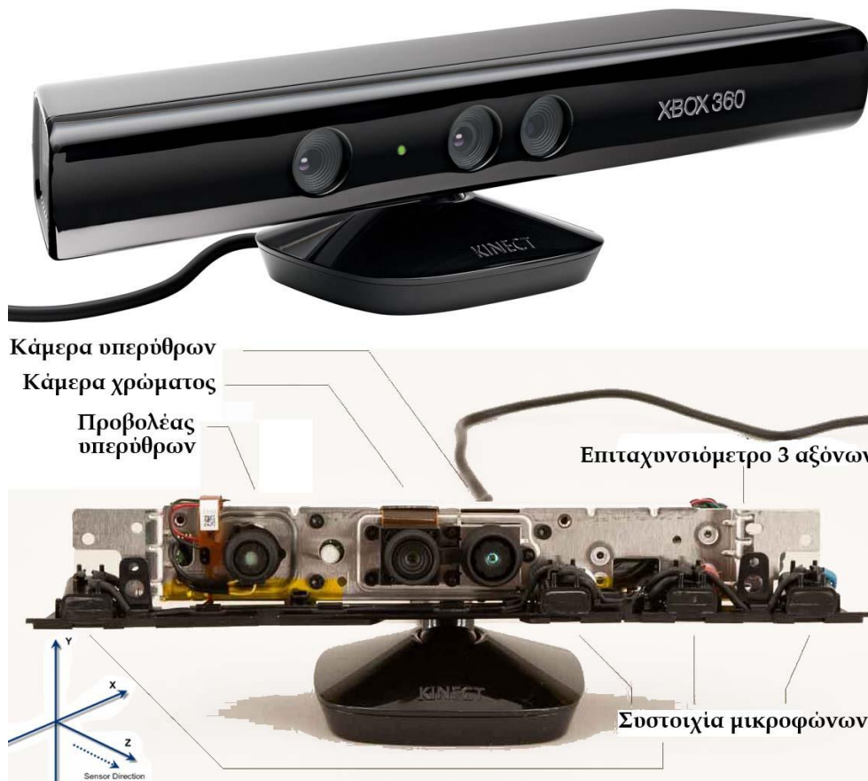
Εικόνα 6-37: Επάνω, άποψη του αισθητήρα αναγνώρισης κίνησης Microsoft Kinect και κάτω τα βασικά λειτουργικά στοιχεία από τα οποία αποτελείται.
