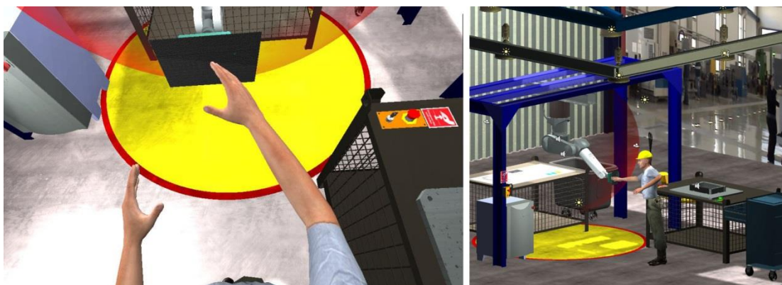
Εικόνα 5-2: Στιγμιότυπα από την πρώτη περίπτωση συνεργασίας (beWare of the Robot v1.0): ο άνθρωπος παραλαμβάνει το τεμάχιο από το ρομπότ στον κοινό χώρο εργασίας
