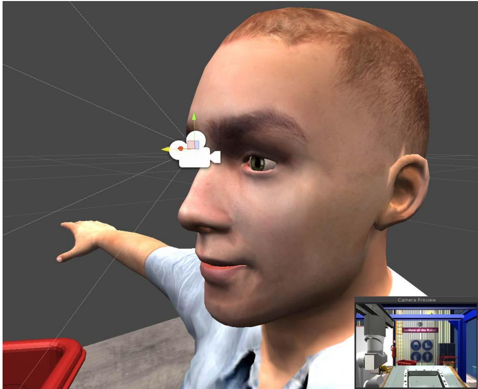
Εικόνα 6-30: Η κύρια κάμερα (main camera) στο ύψος των ματιών του ανθρωποειδούς και η επιτυγχάνόμενη άποψη Α΄ προσώπου στο κάτω δεξιά πλαίσιο.
