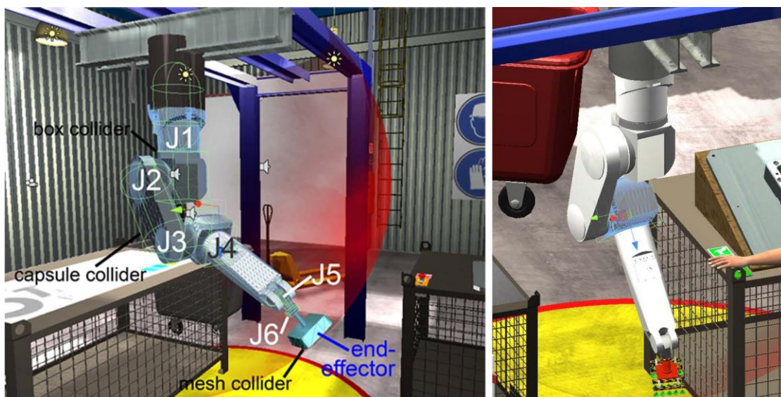
Εικόνα 6-32: Ο ρομποτικός βραχίονας: αριστερά στην έκδοση 1.0/1.5, με την αφαιρετικά-σχεδιασμένη πνευματική αρπάγη στο άκρο του, και δεξιά στη σκηνή της έκδοσης 2.0 με το διαφορετικό σχεδιασμό αρπάγης.
