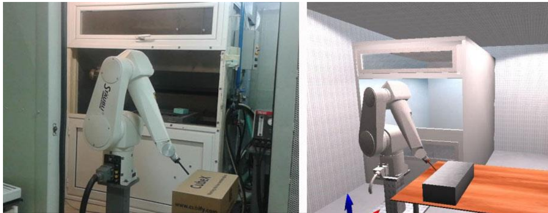
Εικόνα 6-31: Ο βιομηχανικός ρομποτικός βραχίονας Stäubli™ RX 90L: αριστερά, στο Εργαστήριο Τεχνολογίας των Κατεργασιών του ΕΜΠ και δεξιά, σε σκηνή ΕΠε, σε περιβάλλον Unity.
