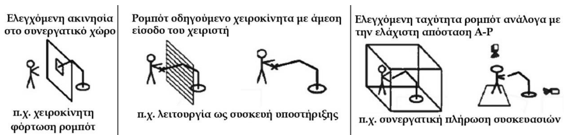
Εικόνα 2-4: Παραστατικές τοπολογίες συνεργατικών καθηκόντων σύμφωνα με το ISO 10218/2011
