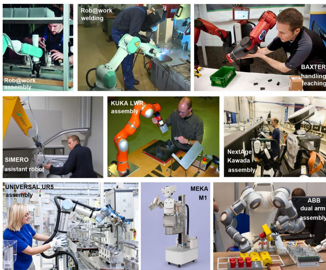
Εικόνα 2-2: Παραδείγματα ρομποτικών βοηθών ανά είδος βιομηχανικής εφαρμογής (Bischoff et al., 2010; Gecks & Henrich, 2004; Helms et al., 2002; Iossifidis et al., 2002; Rethink Robotics, 2013; R.D. Schraft et al., 2005; Vicentini et al., 2014)
