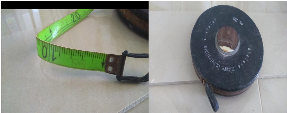
Εικόνα 9. Μετροταινία 25 m κλειστού κελύφους από fiberglass διπλής όψης
