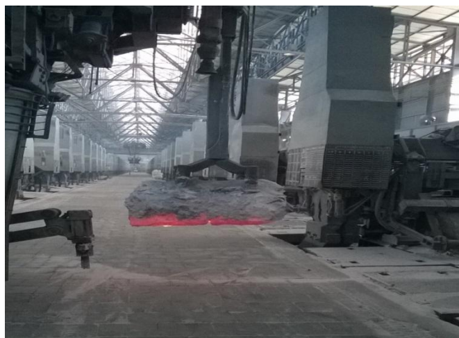
Εικόνα 14. Αλλαγή χρησιμοποιημένης ανόδου
