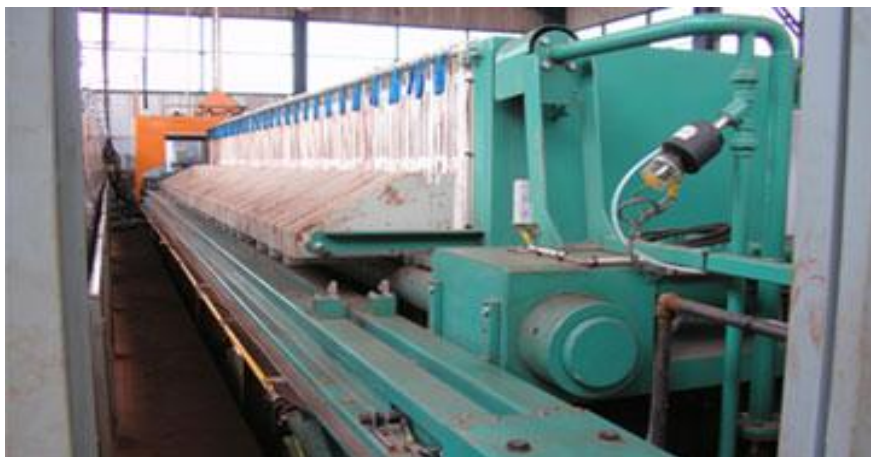
Εικόνα 7 Λειτουργία της πρώτης Φιλτρόπρεσσας Διήθησης Καταλοίπων Βωξίτη
