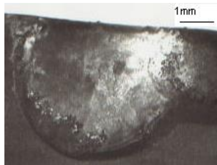
Σχήμα VI-1 : Μακρογραφία ανατηγμένης επίστρωσης WC-17%Co σε χάλυβα SS304L με 14000kW/m 2
