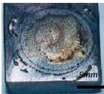
Σχήμα V-2 : Επίστρωση SiC σε χάλυβα St52.3 Μακρογραφία κατεργασμένης επιφάνειας
