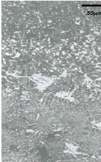
Σχήμα V-35 : Λεπτομέρεια κοντά στη διεπιφάνεια επιστρώσης WC-17Co και χάλυβα St52.3 για χρόνο κατεργασίας t=13\text{min}
