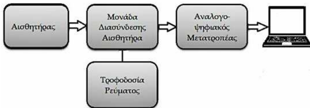
Σχήμα 3.2: Τυπική διάταξη συστήματος μέτρησης.
