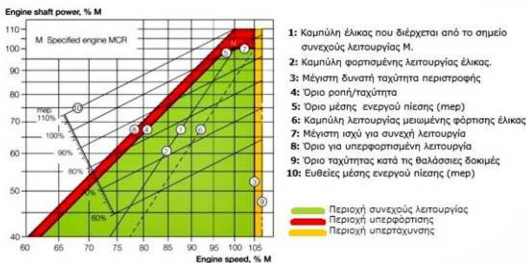
Σχήμα 1.11: Το διάγραμμα φόρτισης της μηχανής
