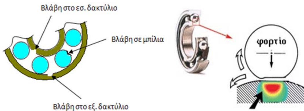
Σήμα 1.4: τύποι βλαβών σε ένσφαιρο ρουλεμάν
