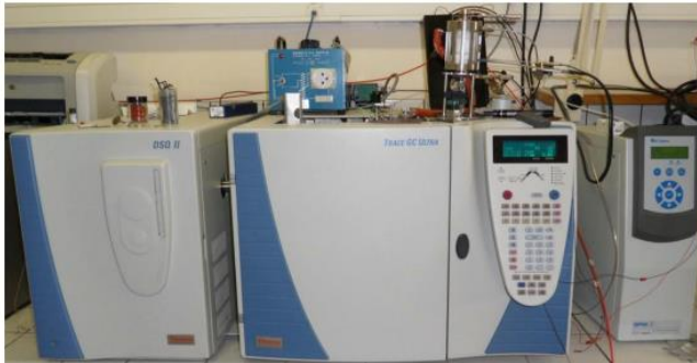
Σχήμα 5.7: α) Ο αέριος χρωματογράφος (ThermoElectron GC-Trace ultra) συνδεδεμένος με φασματοόμετρο μάζας DSQII και τον εισαγωγέα Optic 3/4, β) ο αντιδραστήρας στον οποίο πραγματοποιήθηκαν οι θερμοκοί αιφνιδιασμοί.
