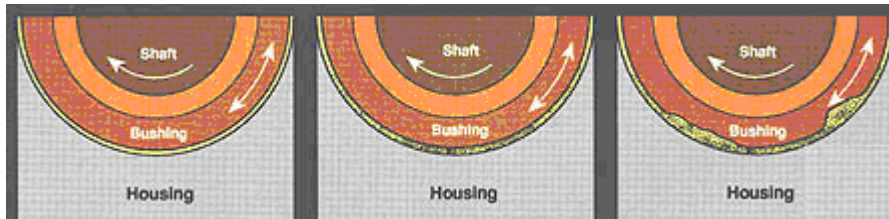
Σχήμα 3.6: Σχηματική απεικόνιση της του φαινομένου της φθοράς παλινδρόμησης [18].
