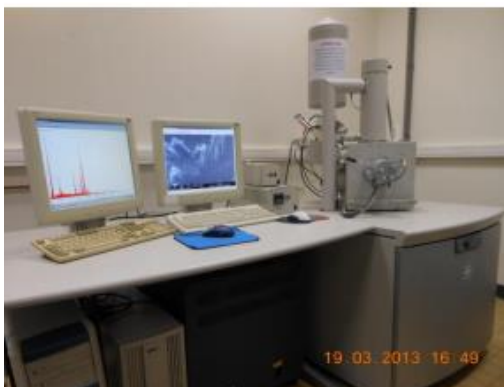
Σχήμα 5.2: Το σύστημα SEM (FEI Quanta 200) με EDAX (EDAX Metek New XL30) που χρησιμοποιήθηκε στην παρούσα εργασία.
