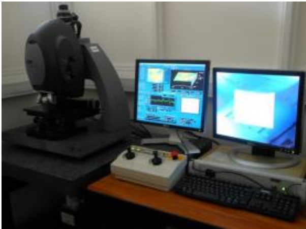
Σχήμα 5.6: Προφιλόμετρο λευκού φωτός (Zygo NewView 6300)
