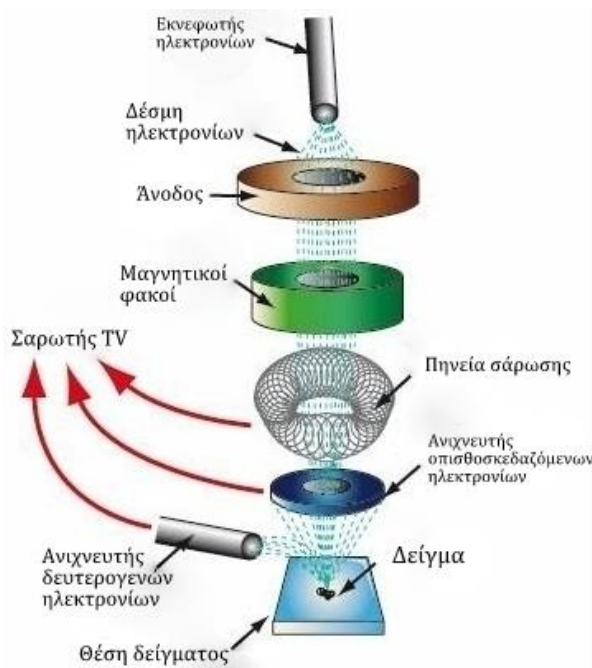
Σχήμα 5.1: Αρχή λειτουργίας Ηλεκτρονικού Μικροσκοπίου Σάρωσης.
