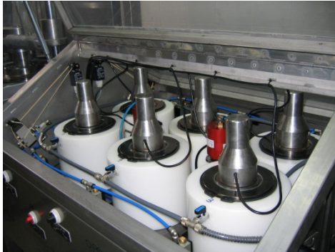
Εικόνα 4-33: Λεπτομερής άποψη της μονάδας με τα 6 κελιά ΥΥΠ των 42ml το καθένα.
