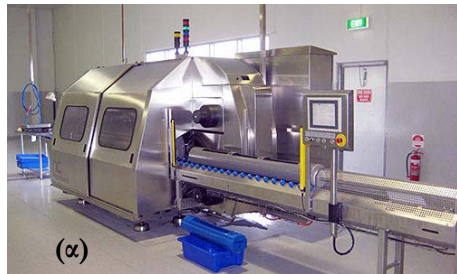
Εικόνα 1-19 - Εξοπλισμός ΥΥΠ βιομηχανικής κλίμακας (α) οριζόντιας θέσης (Wave 600/55, NC Hyperbaric) και (β) κάθετης θέσης (215L-600 HPP System, Avure)
