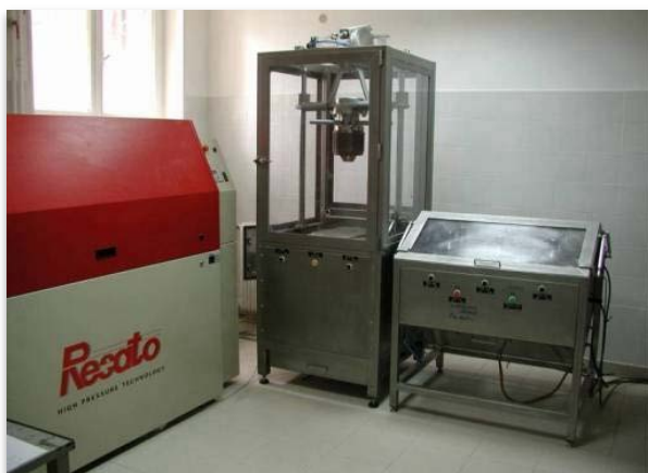
Εικόνα 4-36: Γενική άποψη του Εργαστηρίου Υπερυψηλής Πίεσης και της μονάδας ΥΠ. Στο κέντρο διακρίνεται η μονάδα για την επεξεργασία τροφίμων όγκου μέχρι 1,5lt και στα δεξιά η μονάδα με τα 6 δοχεία ΥΠ των 42mL το καθένα.
