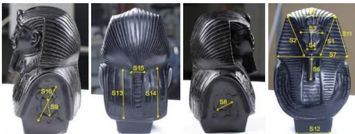
Εικόνα 70: Αποστάσεις ελέγχου που μετρήθηκαν στο μασόνιο αντικείμενο
