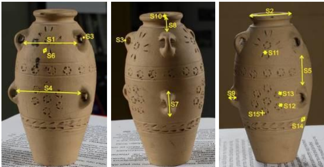
Εικόνα 72: Αποστάσεις ελέγχου που μετρήθηκαν στο πήλινο αντικείμενο
