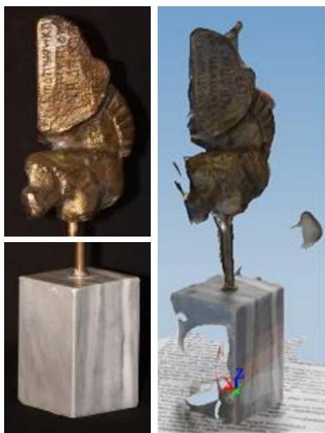
Εικόνα 34: Επιστροφή 123dCatch για το χάλκινο και το μαρμάρινο αντικείμενο
