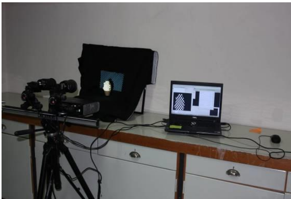
Εικόνα 6: Σαρωτής Δομημένου Φωτός και Ρυθμίσεις Φωτισμού
