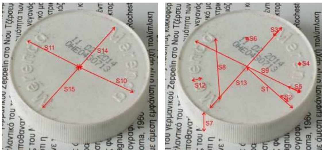
Εικόνα 69: Αποστάσεις ελέγχου που μετρήθηκαν στο πλαστικό αντικείμενο
