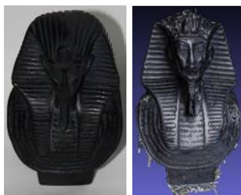
Εικόνα 21: Επιστροφή ARC3D για το μαονένιο αντικείμενο
