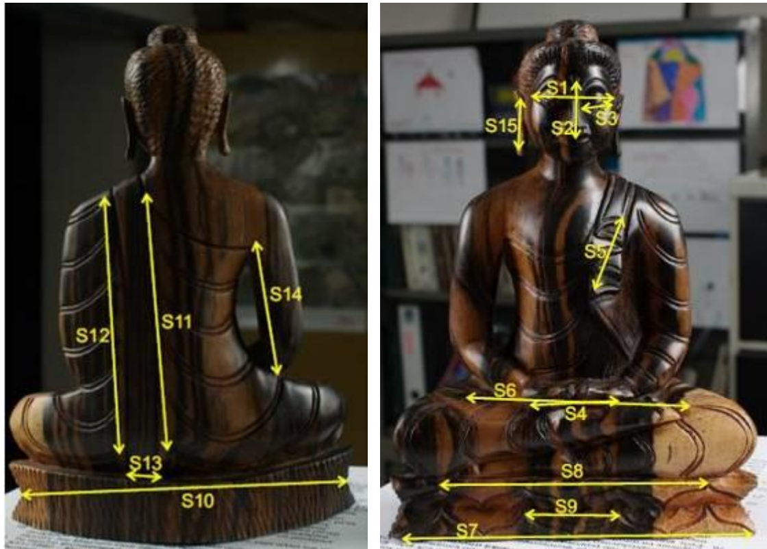
Εικόνα 71: Αποστάσεις ελέγχου που μετρήθηκαν στο ξύλινο αντικείμενο
