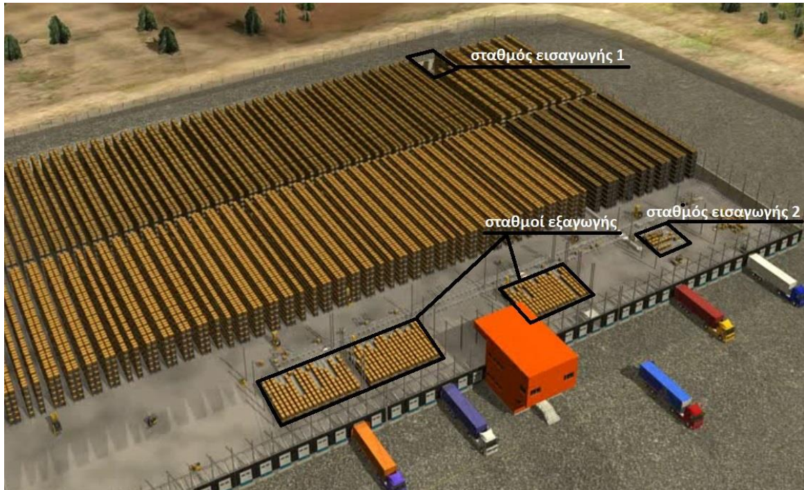
Εικόνα 2-10 Κάτοψη σταθμών εισαγωγής/εξαγωγής
