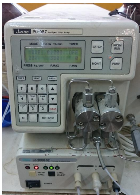
Εικόνα 9: Αντλία συστήματος Υγρής Χρωματογραφίας Jasco PU-987 σε λειτουργία.
