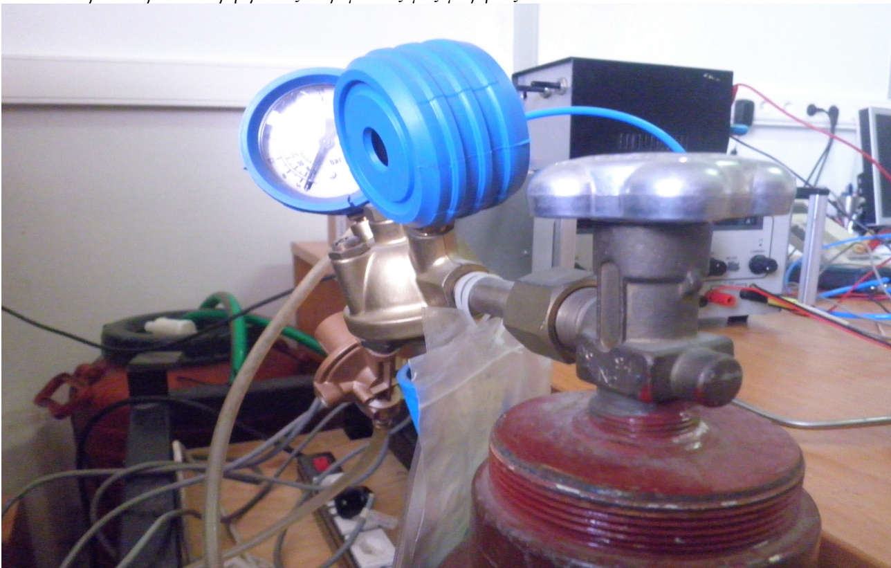
Εικόνα 48: Στην παραπάνω εικόνα βλέπουμε τη φιάλη παροχής του αερίου ARGON καθώς και τον χειροκίνητο ρυθμιστή ροής (Gas Flow Controller). -119-
