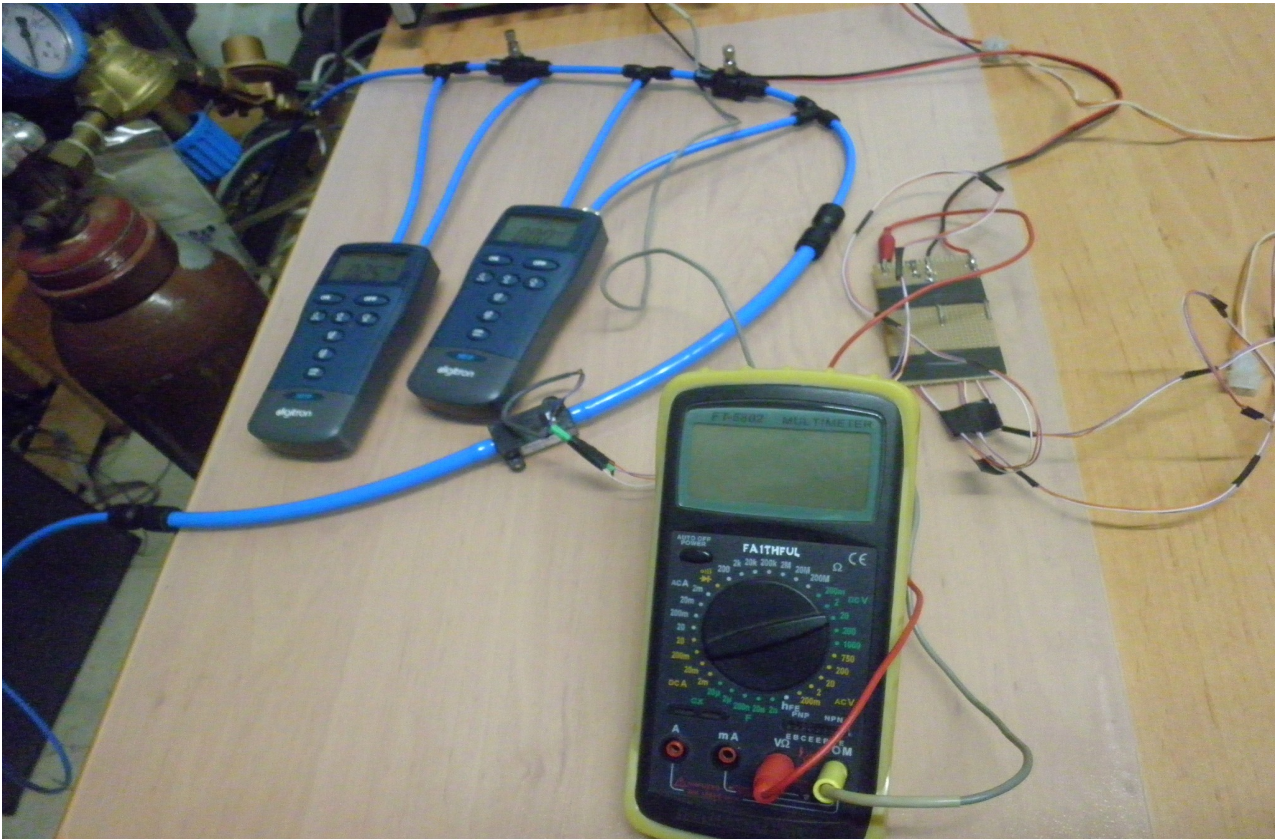
Εικόνα 50: Στην παραπάνω εικόνα στα αριστερά παρατηρούμε τα δύο μανόμετρα υψηλής ακρίβειας του εργαστηρίου κοσμικών ακτίνων του τομέα Φυσικής του Ε.Μ.Π.
