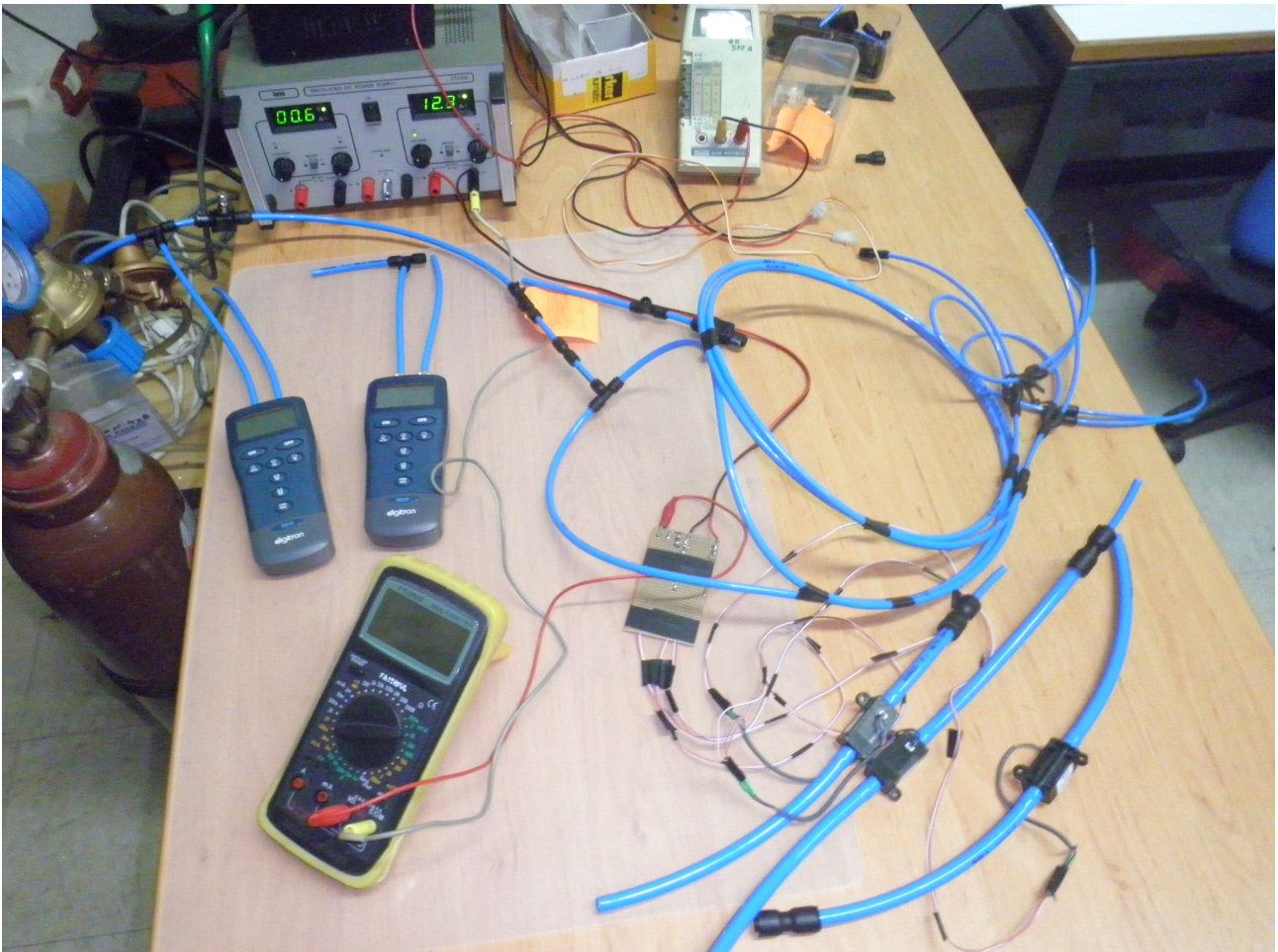
Εικόνα 52: Στην παραπάνω εικόνα, παρατηρούμε την συνδεσμολογία της πειραματικής διάταξης του διανομέα ροής αερίου και παρατηρούμε όλα τα εξαρτήματά του ( 2 μανόμετρα, αμπερόμετρο στα αριστερά κ.τ.λ.π). Η φωτογραφία ανήκει στο προσωπικό αρχείο του συγγραφέα (Γιάννη Κολυβοδιάκου).
