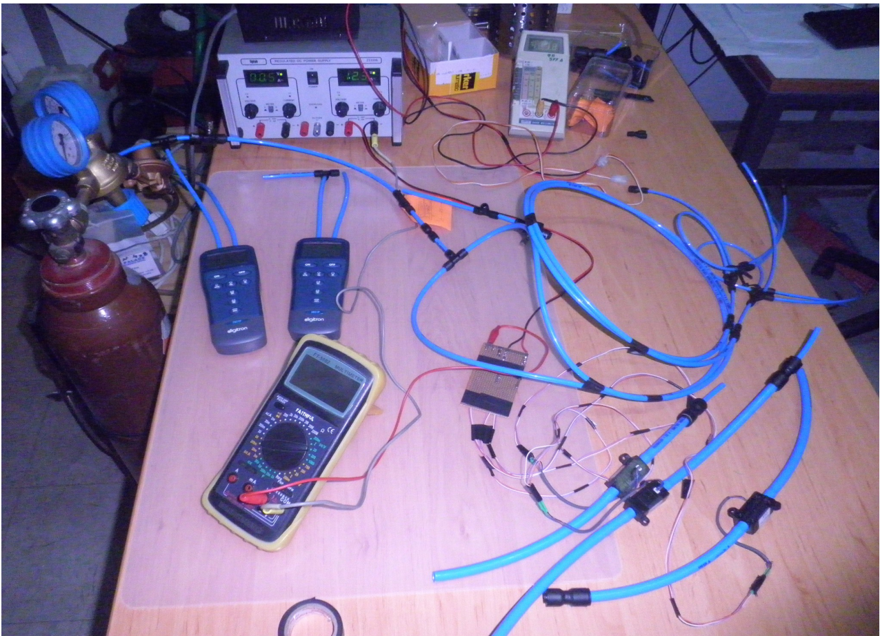
Εικόνα 46: Στο παραπάνω σχήμα βλέπουμε την πειραματική διάταξη του διανομέα ροής αερίου. Παρατηρούμε όλα τα όργανα και εξαρτήματα από τα οποία αποτελείται η πειραματική διάταξη του εργαστηρίου κοσμικών ακτίνων του τομέα Φυσικής του Ε.Μ.Π. Τη φωτογραφία την έβγαλε ο συνάδελφος Αντώνης Γιαννόπουλος.
