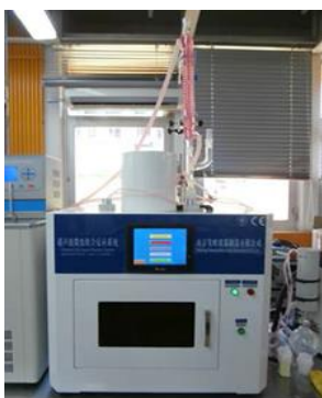
Εικόνα 13. Συσκευής εκχύλισης υπερήχων εργαστηρίου ΣΑΔ (Nanjing Xianou Instruments Manufacture co.,Ltd., Nanjing City, China)
