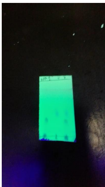
Εικόνα 35: Πλάκα TLC κάτω από πηγή υπεριώδους ακτινοβολίας
